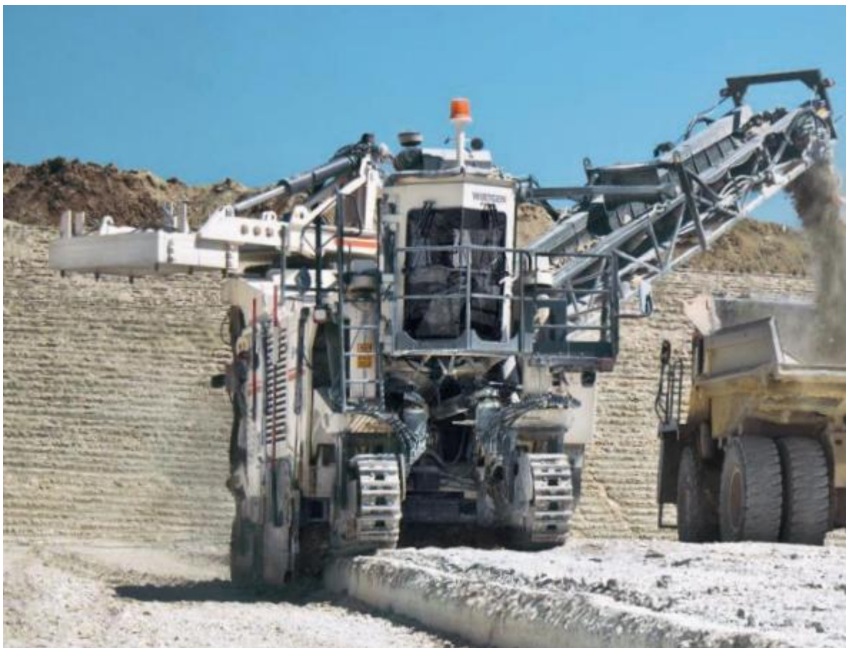
Рисунок 4.8 – Карьерный комбайн Wirtgen 2500 SM при отработке и погрузке известняка [110]
