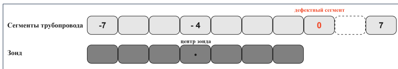
Рисунок 3.6 – Схема расположения зонда относительно трубопровода (по сегментам) (составлено автором)
