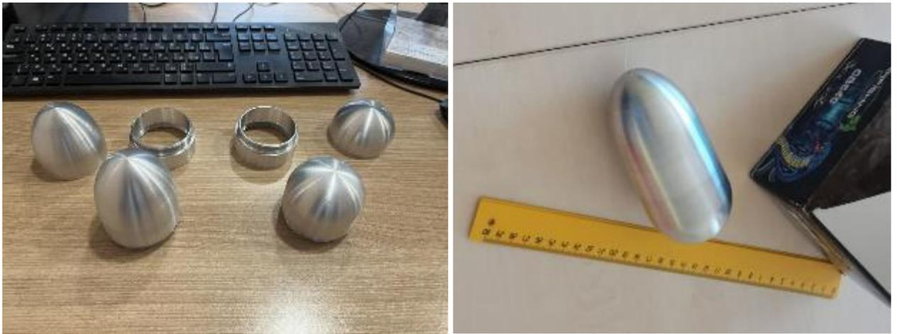
Рисунок 3.5 – Изготовленная модель капсулы для первичного эксперимента
