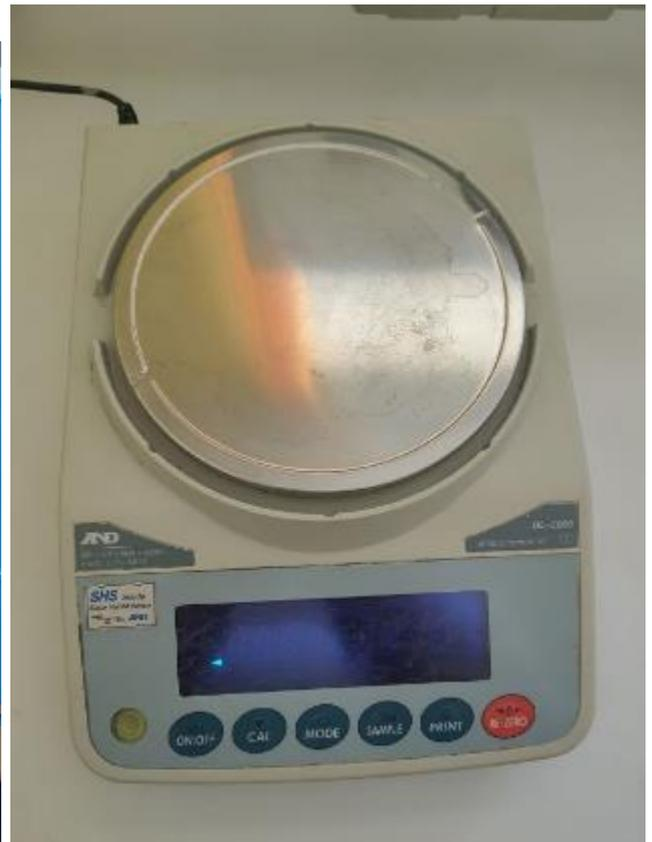
Рисунок 3.6 – Использованные весы для определения массы капсулы, DL-5000 компании «AND»
