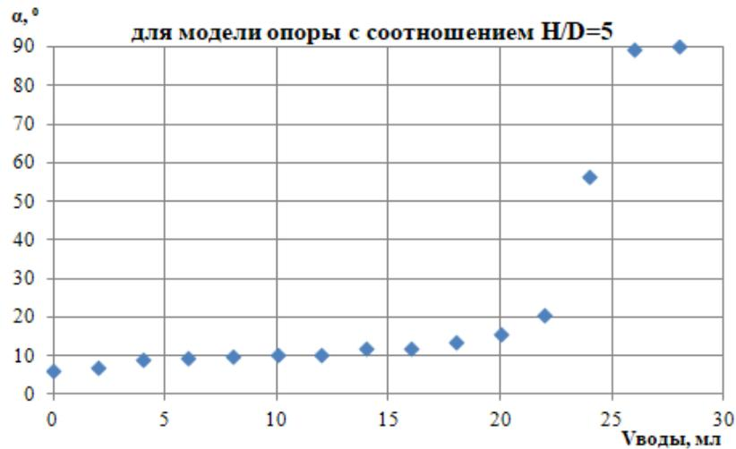
Рисунок 3.10 – Изменение крена модели опоры в зависимости от объема балласта для образца с соотношением  $H/D = 5$  (составлено автором)
