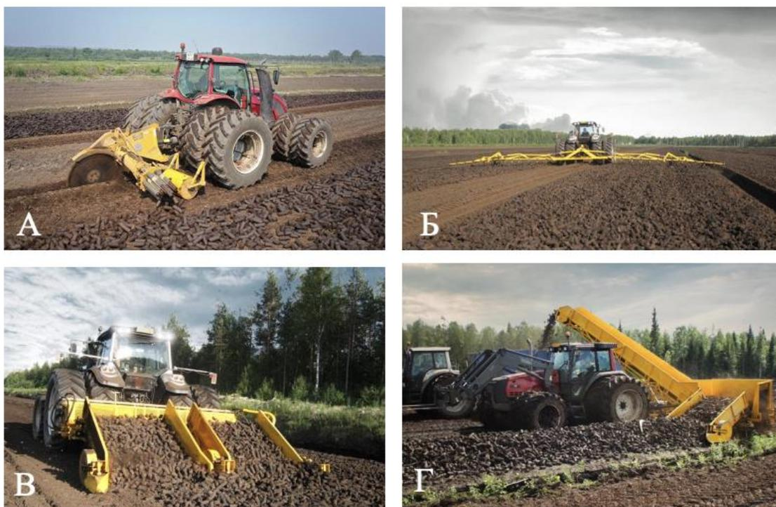
Рисунок 1.11 – Техника, применяемая при фрезформовочном способе добычи: А – экструдер с плоским торцом *PK 1 SL R12* производителя *Meripeat* [117]; Б – борошиллка *KNH-18 Meripeat* [117]; В – валкователь *KA-4.0 T Meripeat* [117]; Г – погрузчик кускового торфа *КНТ-2.0 Meripeat* [117]
