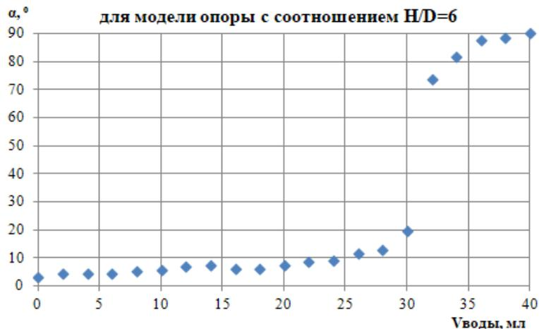
Рисунок 3.11 – Изменение крена модели опоры в зависимости от объема балласта для образца с соотношением  $H/D = 6$  (составлено автором)
