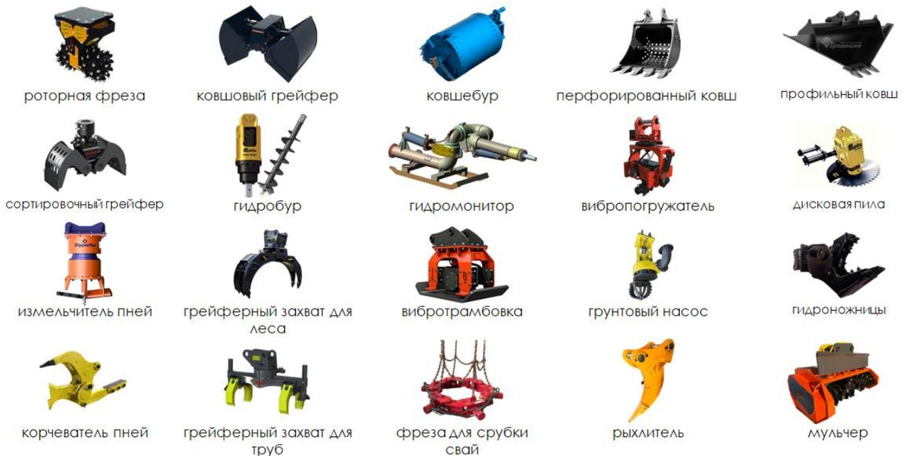
Рисунок 2.8 – Виды сменного оборудования для гидроманипулятора
