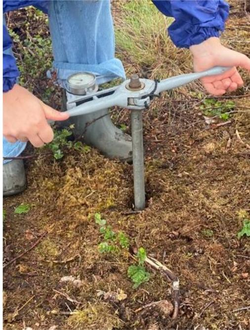
Рисунок 3.19 – Процесс погружения сдвигомера-крыльчатки СК-10
