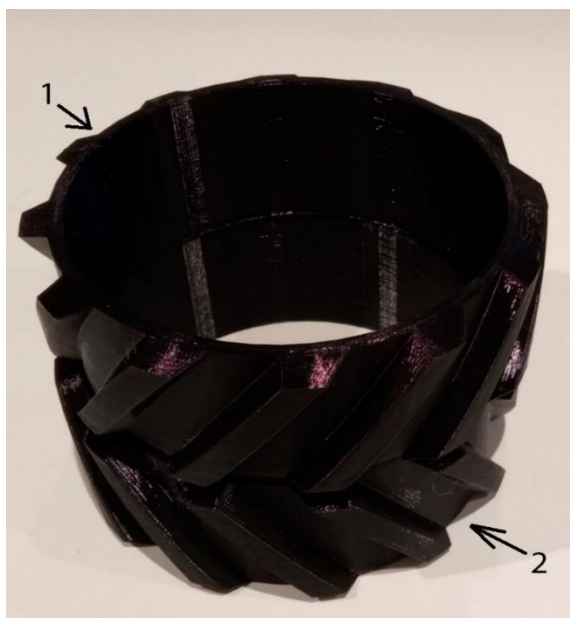
Рисунок 5.1.1 – Опытный образец центратора – турбулизатора для бурильных труб с вращающимся элементом, где 1 – первый диск, 2 – второй диск, вращающийся
