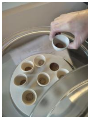
Рисунок 3.18 – Определение органического вещества (процесс извлечение навоза из эксикатора перед взвешиванием) [составлено автором]
