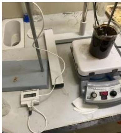
Рисунок 3.12 – Пример получения минеральной почвенной добавки (при обработке НЦСО раствором КОН концентрацией 10,0% масс.) [составлено автором]
