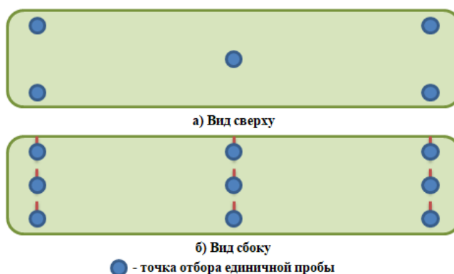
Рисунок 2.3 – Схема отбора проб из одного геотуба [составлено автором]
