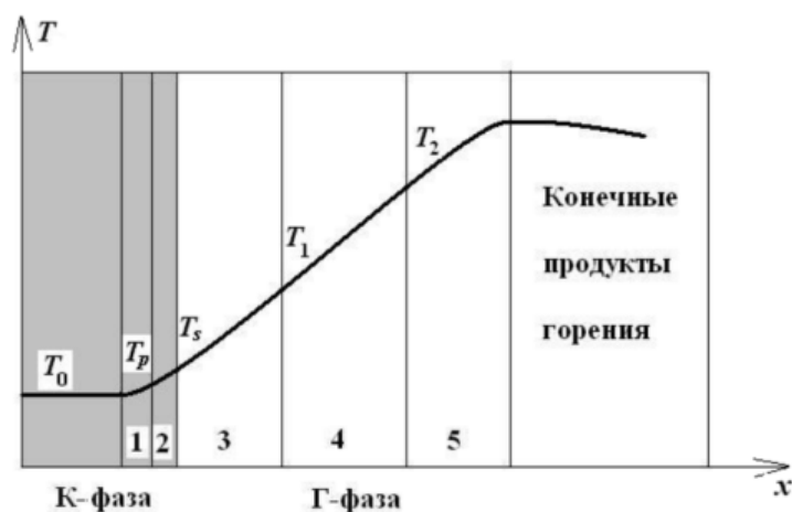
Рисунок 2.1 – Схема процесса горения НЦ и продуктов на её основе [181]
