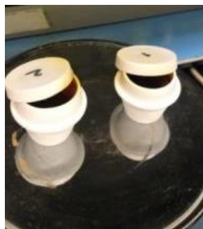
Рисунок 2.12 – Выпаривание азотной кислоты для определения зольности [составлено автором]
