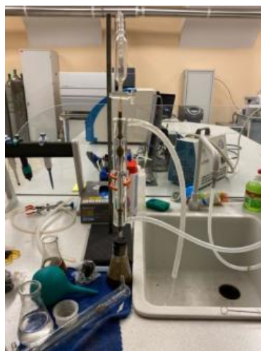
Рисунок 3.6 – Определение динамической вязкости на вискозиметре ВПЖ-3 №27 [составлено автором]
