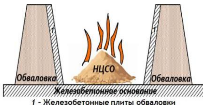
Рисунок 2.15 – Общая схема площадки сжигания [составлено автором]
