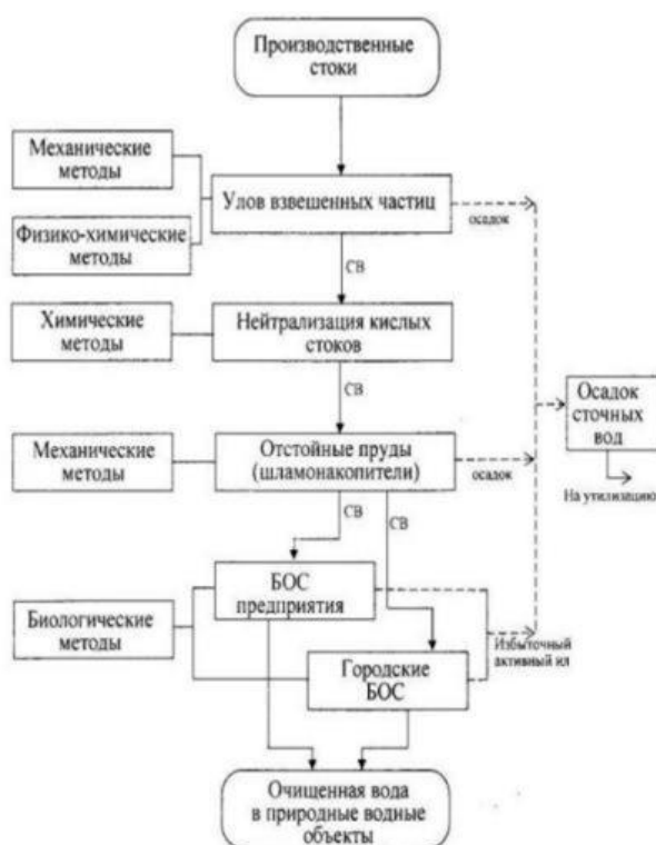
Рисунок 1.4 – Принципиальная схема очистки сточных вод предприятий по производству НЦ-содержащей продукции и образования НЦСО [90]
