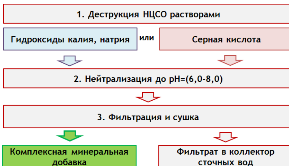
Рисунок 3.16 – Принципиальная схема получения комплексных минеральных почвенных добавок [составлено автором]
