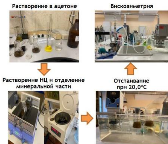
Рисунок 3.5 – Этапы определения степени полимеризации НЦСО [составлено автором]
