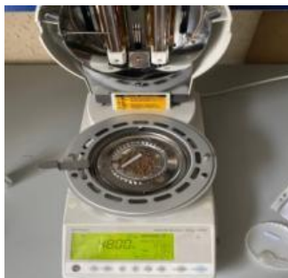
Рисунок 2.5 – Определение влажности НЦСО при помощи влагомера Shimadzu MOC-120H [составлено автором]
