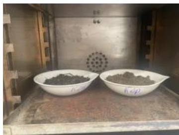
Рисунок 3.17 – Определение влажности отходов животноводства (процесс загрузки фарфоровых чашек в сушильный шкаф) [составлено автором]
