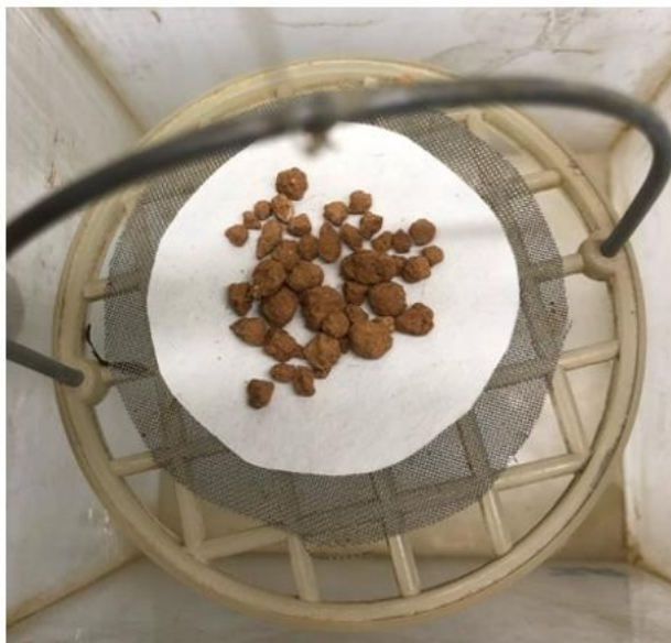
Рисунок 3.8 – Результаты испытания на размокание класса -5 мм выведенной из орошения руды спустя 2 часа 10 минут
