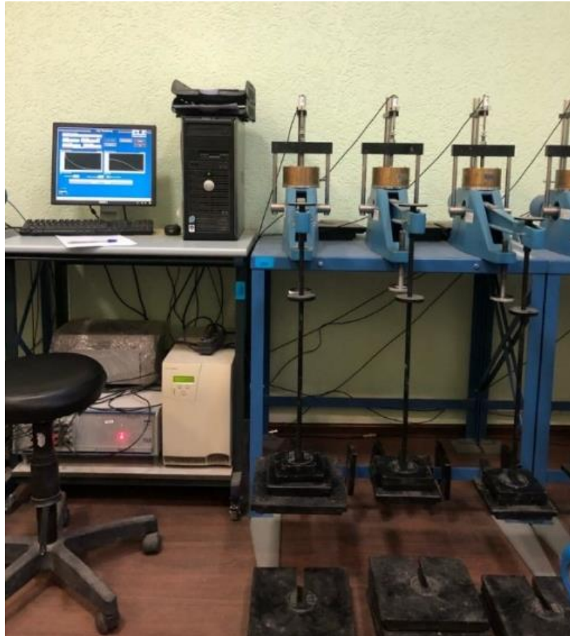
Рисунок 3.18– Оборудование для компрессионных испытаний ELE International
