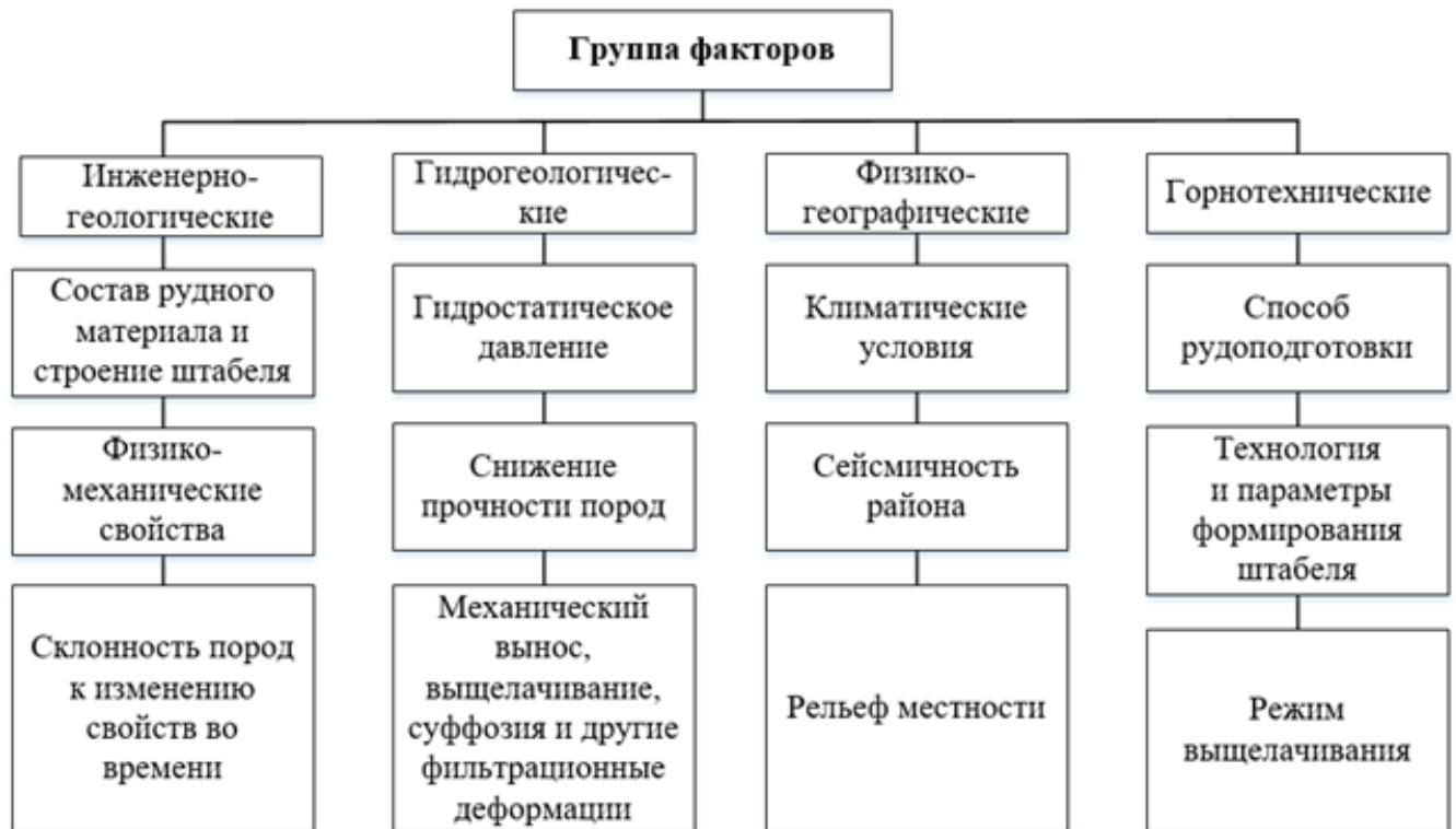
Рисунок 1.5 – Факторы, определяющие устойчивость штабелей КВ на основе [113] с дополнениями
