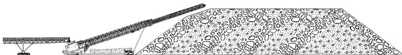
Рисунок 4.6 – Схема строения структуры штабеля при укладке руды стакером в один ряд
