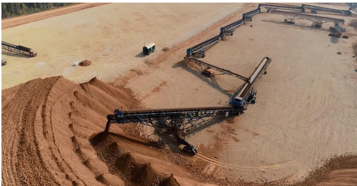
Рисунок 2.8 – Укладка окомкованной руды в штабель КВ при помощи стакера [80]
