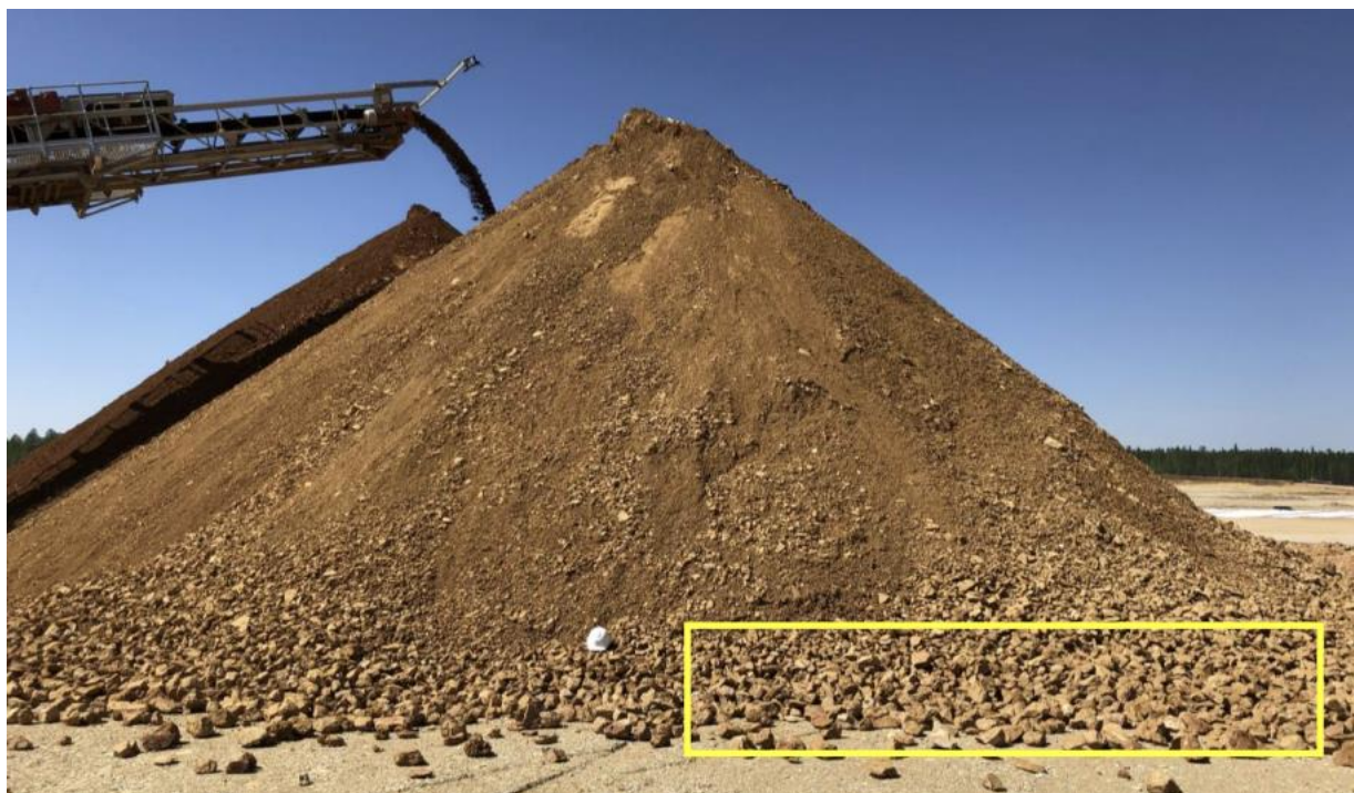
Рисунок 4.4 – Зоны скопления крупной фракции в процессе сегрегации материала в основании штабеля КВ при его формировании
