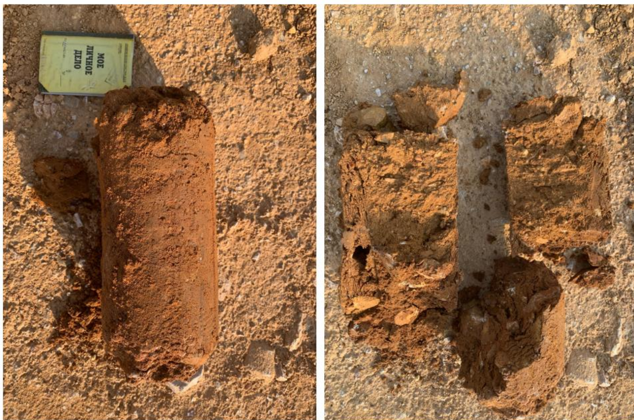
Рисунок 3.31 – Фото керна из скважины №1 (глубина 16,10-16,30 м)
