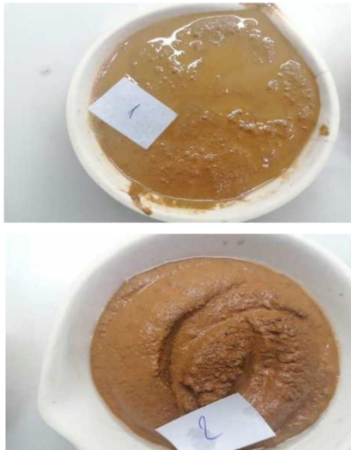
Рисунок 3.13– Материал класса -5 мм после испытания в фильтрационном приборе
