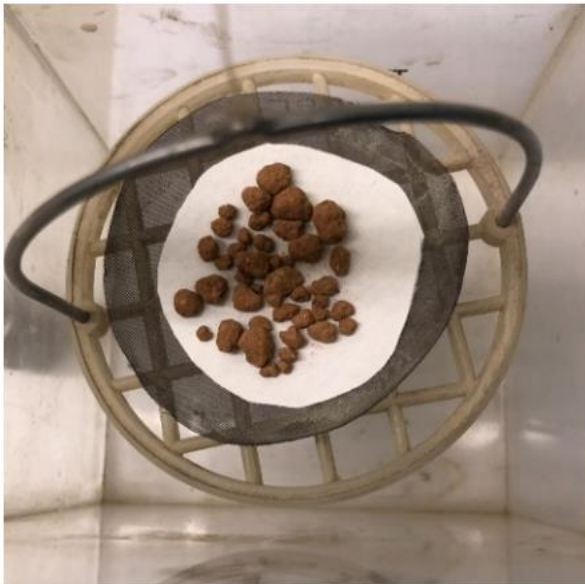
Рисунок 3.7 – Результаты испытания на размокание класса -5 мм свежеекомкованной руды спустя 2 часа 10 минут
