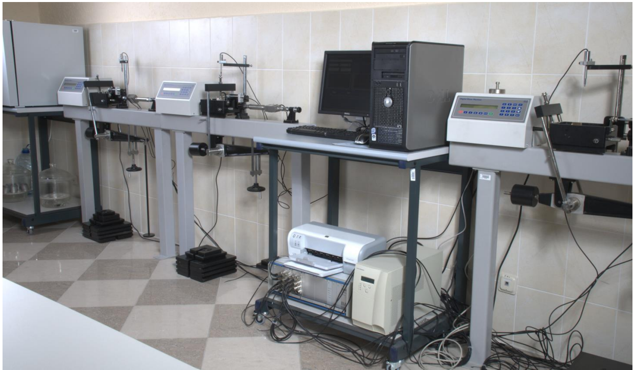
Рисунок 3.14 – Оборудование для испытаний на одноплоскостной срез ELE International
