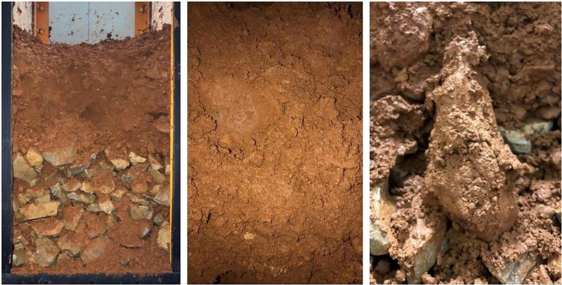
Рисунок 3.26 – Материал после испытания на полное водонасыщение
