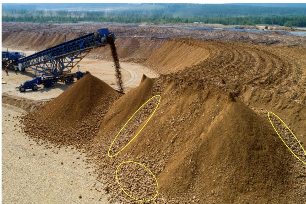
Рисунок 4.3 – Зоны скопления крупной фракции в процессе сегрегации материала при формировании штабеля КВ
