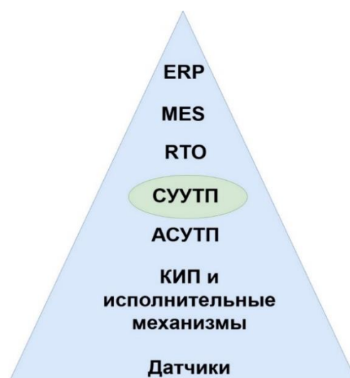
Рисунок 1.8 – Типовая структура уровней автоматизации
