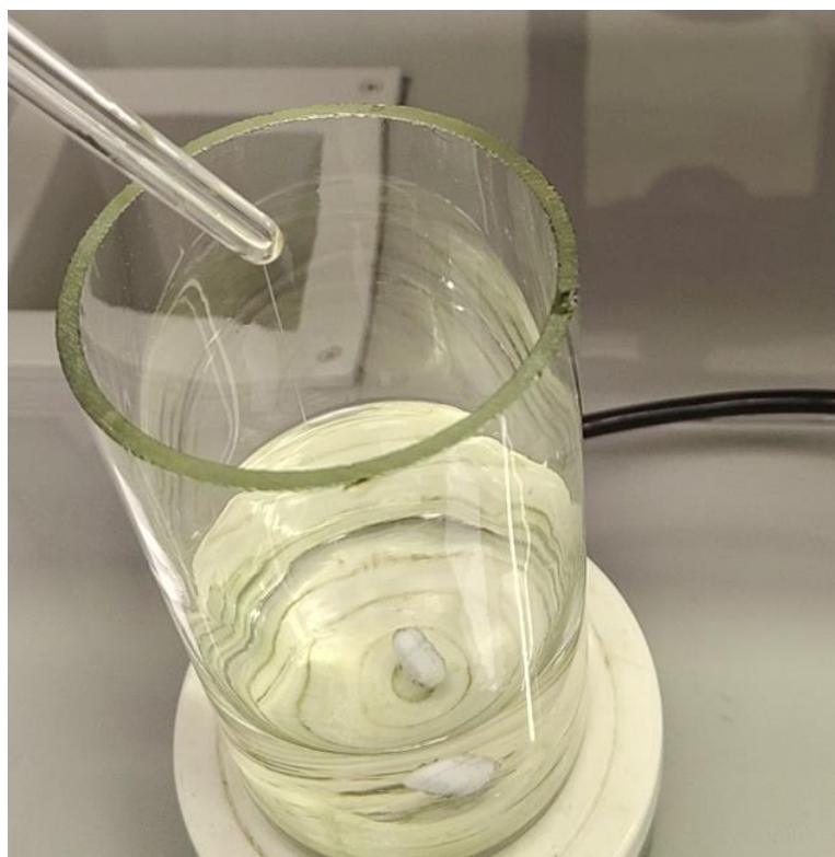
Рисунок 2.12 – Готовая суспензия флокулянта Flomin AL P 99 VHM. Материалы автора
