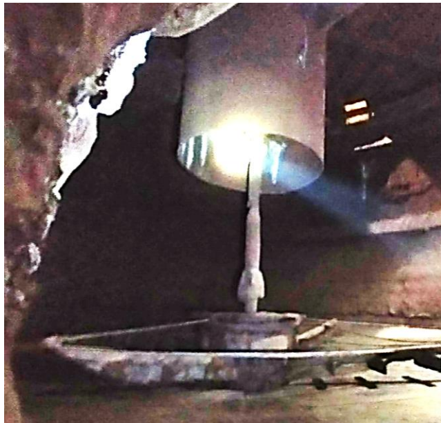
Рисунок 1.5 – Классический цилиндрический питающий стакан. Материалы по результатам производственной стажировки
