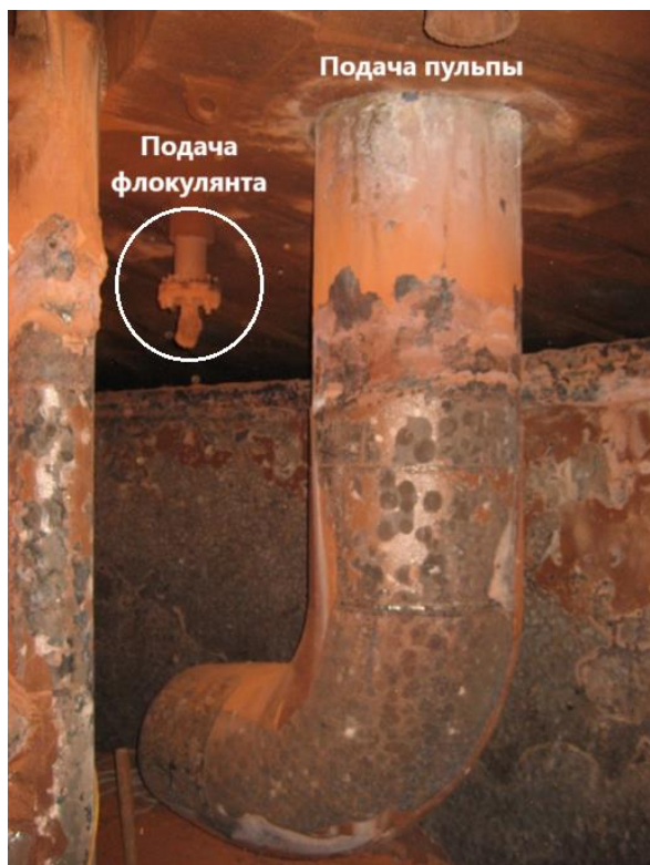
Рисунок 2.2 – Дозирование флокулянта в питающий стакан. Материалы РУСАЛ Windalco
