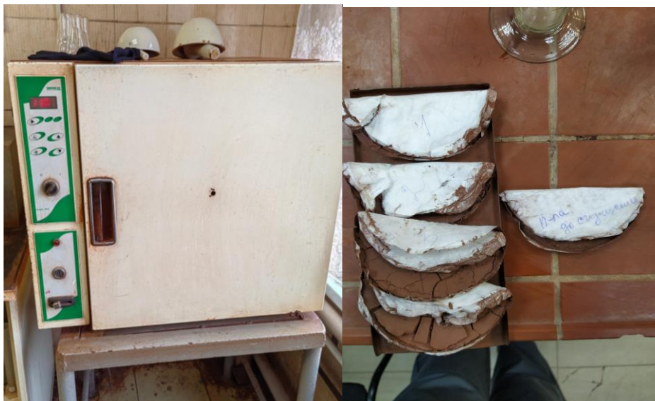
Рисунок 3.11 – Сушильный шкаф ЭКРОС ПЭ-4610 и осушенные пробы. Материалы по результатам производственной стажировки
