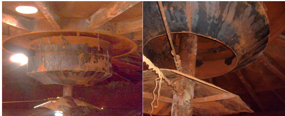
Рисунок 1.6 – Питающий стакан с юбкой на валу. Материалы РУСАЛ Windalco
