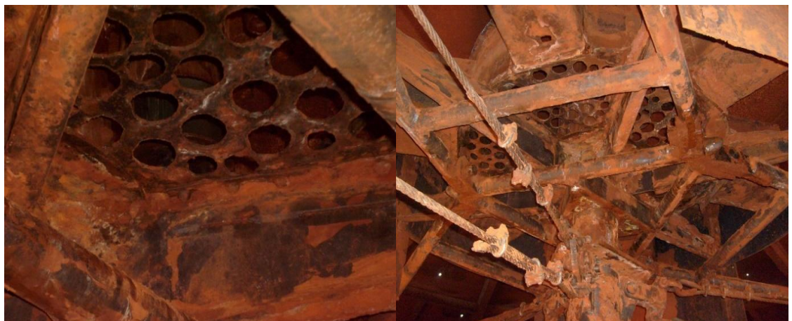
Рисунок 1.7 – Питающий стакан с разделительной сеткой. Материалы РУСАЛ Windalco
