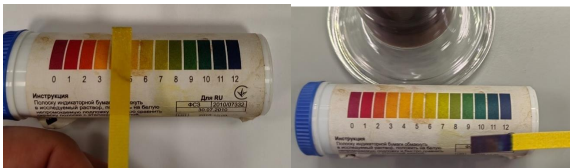
Рисунок 2.11 – Определение pH раствора. Материалы автора
