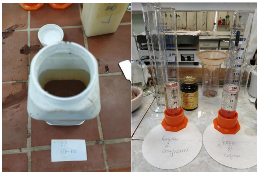
Рисунок 4.3 – Отбор проб противоточной воды каждого промывателя
