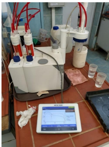
Рисунок 4.4 – Определение содержания щелочи в промывной воде методом титрования Mettler Toledo T5
