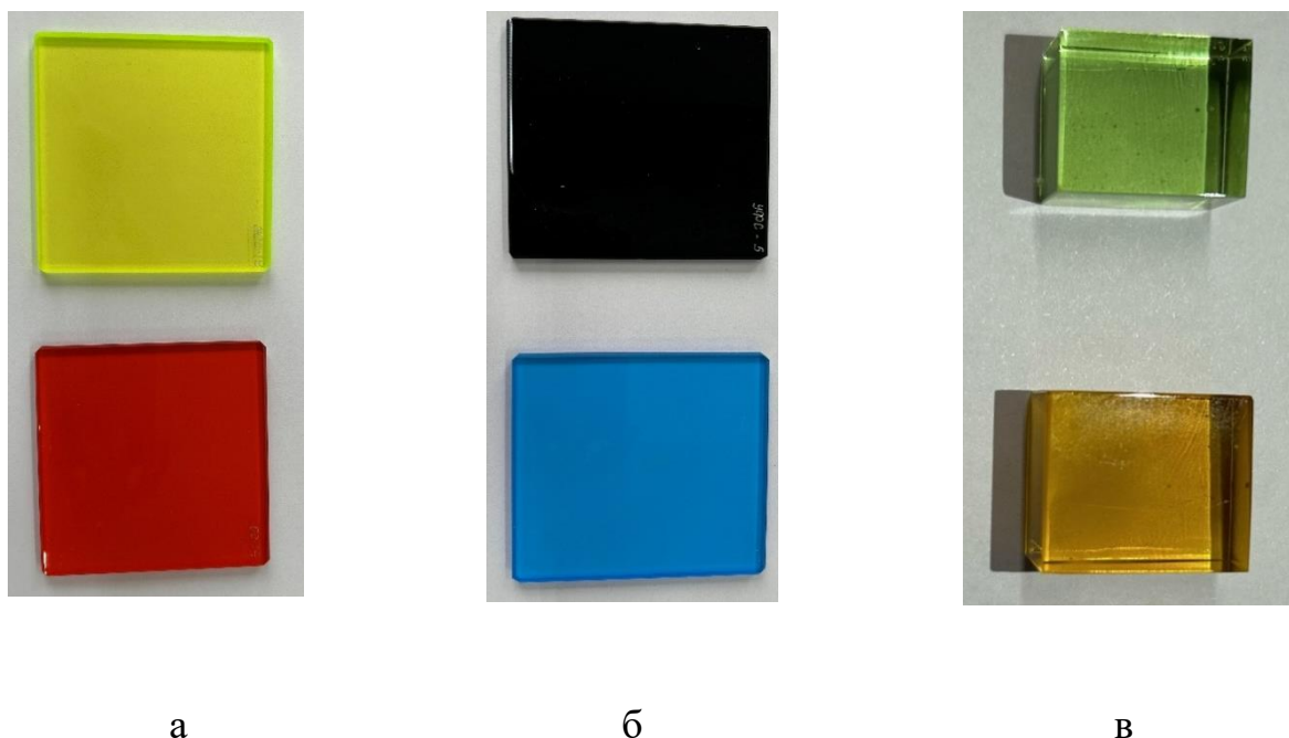
Рисунок 46 – Фосфатные светофильтры, с добавлением в качестве красителя: а) CdS и Se, б) CoO и MnO 2 , в) Fe 2 O 3 и K 2 Cr 2 O 7
