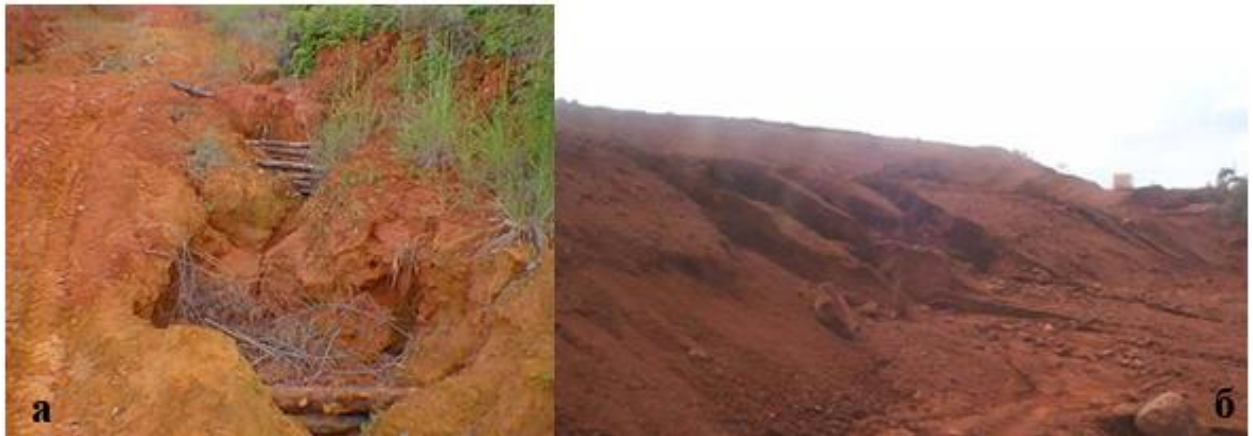
Рисунок 2.10 – Эрозионные процессы: а) эрозия в районе исследования (фото автора); б) эрозия на откосах никелевого месторождения (фото из архива горного управления компании «Эрнесто Гевара», Куба)
