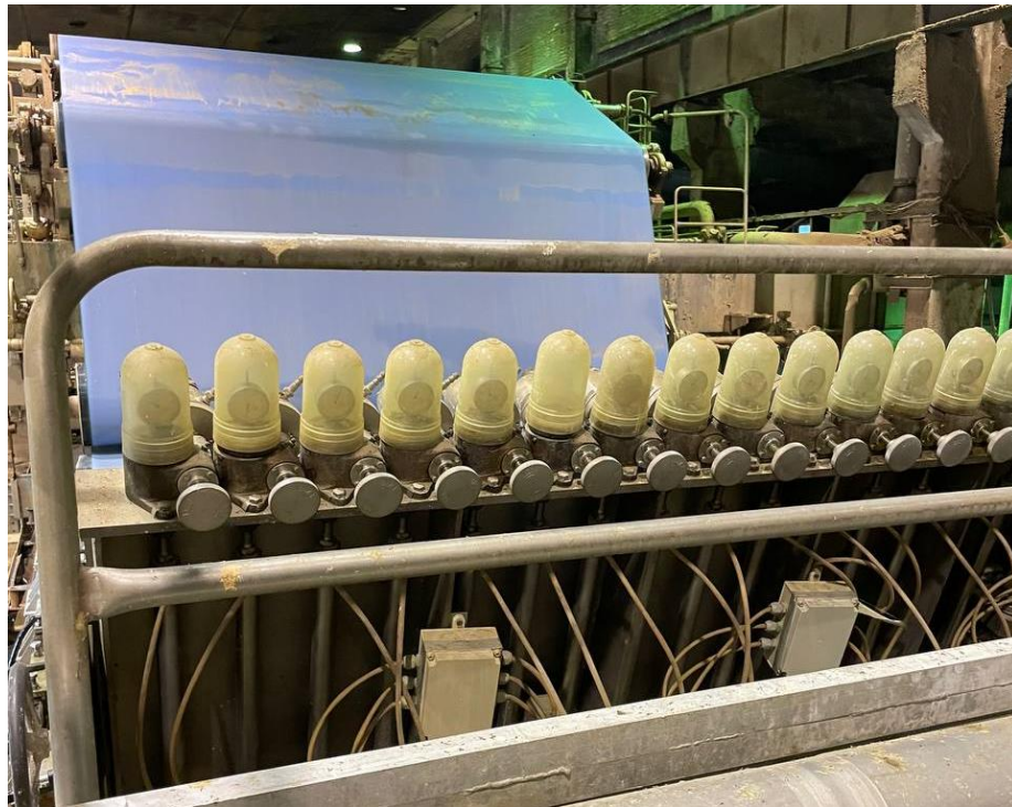
Рисунок 4.3 – «Барашки» для ручного управления (фото автора)
