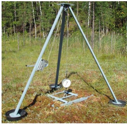
Рисунок 38 – Эксперимент по определению усилия отрыва захваченного материала из торфяного массива (составлено автором)
