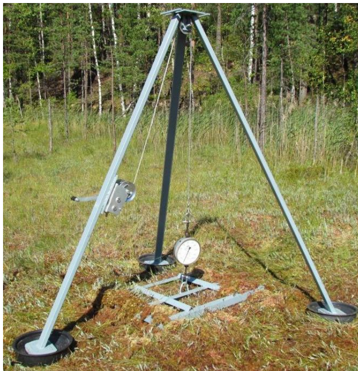
Рисунок 30 – Экспериментальный стенд по исследованию отрыва захваченной порции материала из торфяного массива (фото автора)
