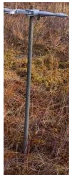
Рисунок 22 – Сдвигомер-крыльчатка СК-10: 1 – крыльчатка; 2 – корпус; 3 – штанга; 4 – втулка крепления; 5 – рукоятка; 6 – втулка; 7 – корпус динамометра; 8 – плоская пружина; 9 – призма; 10 – крепление пружины; 11 – вилка для фиксации корпуса динамометра на штанге; 12 – нажимное устройство; 13 – индикатор часового типа [18]
