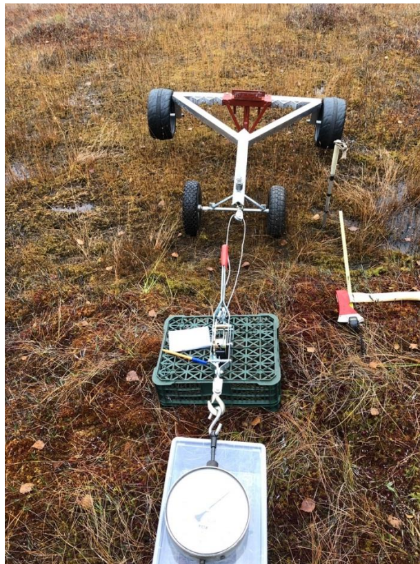
Рисунок 29 – Экспериментальный стенд по исследованию сдвига торфяной залежи в естественном залегании (фото автора)
