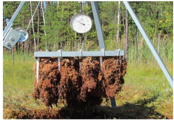
Рисунок 38 – Эксперимент по определению усилия отрыва захваченного материала из торфяного массива (составлено автором)
