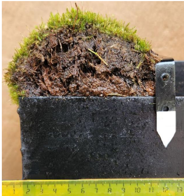
Рисунок 33 – Выпираание материала при сжатии образца (фото автора)
