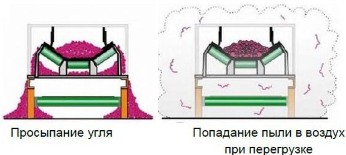
Рисунок 1.2.1 - Способы попадания угольной пыли в воздух при транспортировании угля на ленточном конвейере [65]
