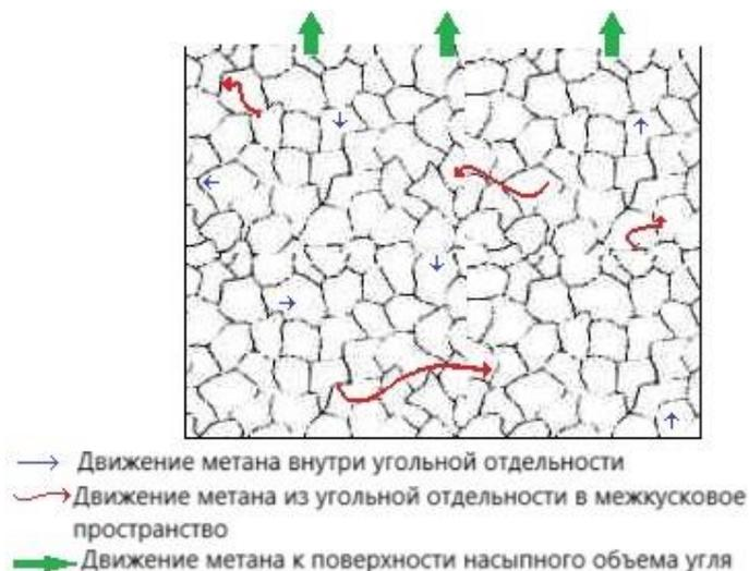
Рисунок 2.2.3 - Схема движения метана при отторжении угольных кусков
