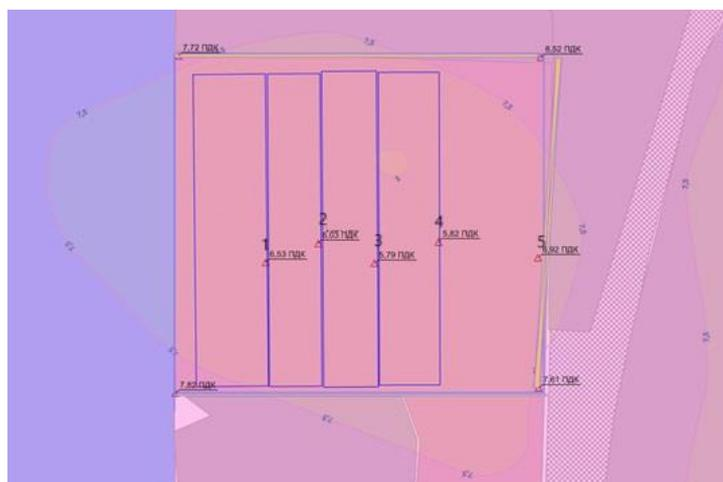
Рисунок 1.2.4 - Изолинии концентрации угольной пыли по территории склада
