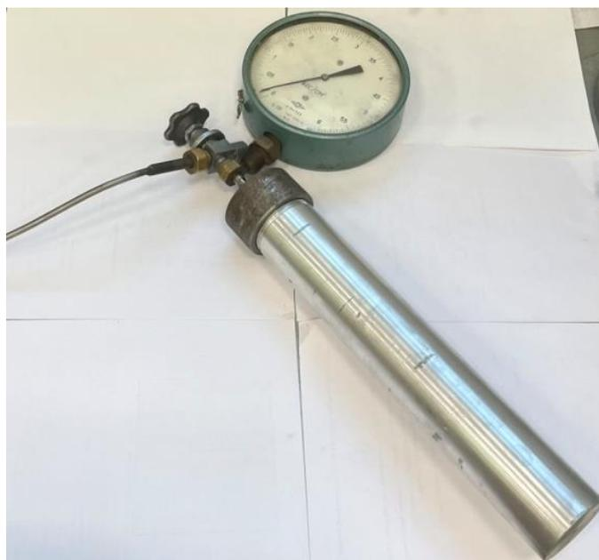
Рисунок 3.2.2 - Капсула высокого давления с манометром
