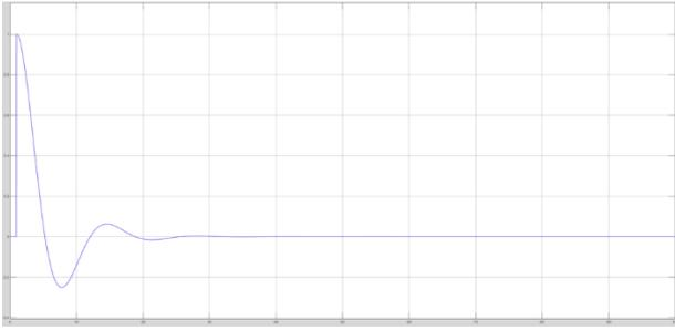
Рисунок В.29 – Переходный процесс при параметрах:  $\bar{k}T_1T_2$
