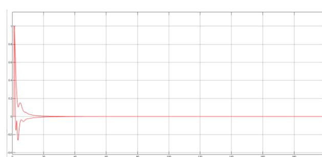
Рисунок Ж.9 – Переходный процесс при робастно-адаптивных и робастных настройках, минимальная разница
