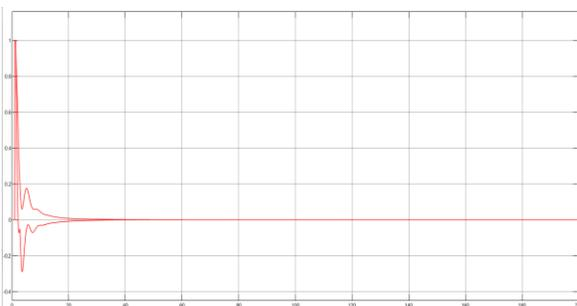
Рисунок Ж.8 – Переходный процесс при робастных настройках, максимальная разница
