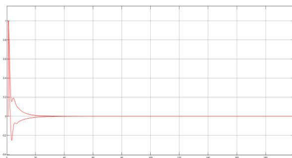
Рисунок Ж.5 – Переходный процесс при робастных настройках, максимальная разница
