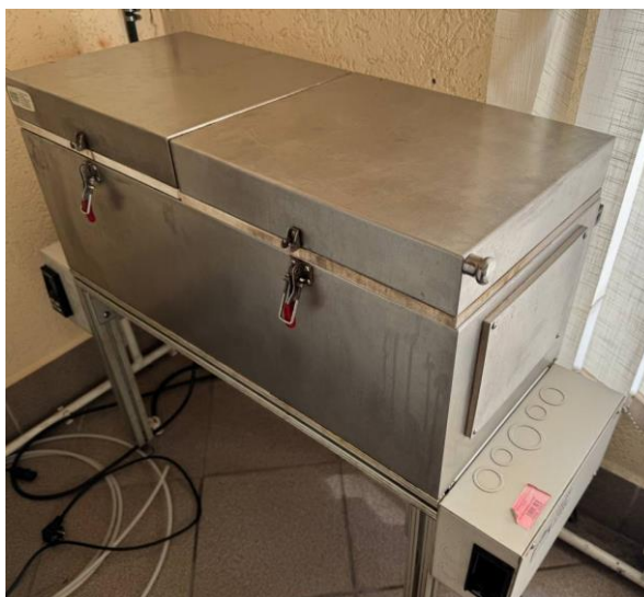
Рисунок 20 – Внешний вид реторты для анализа керна (фото автора)
