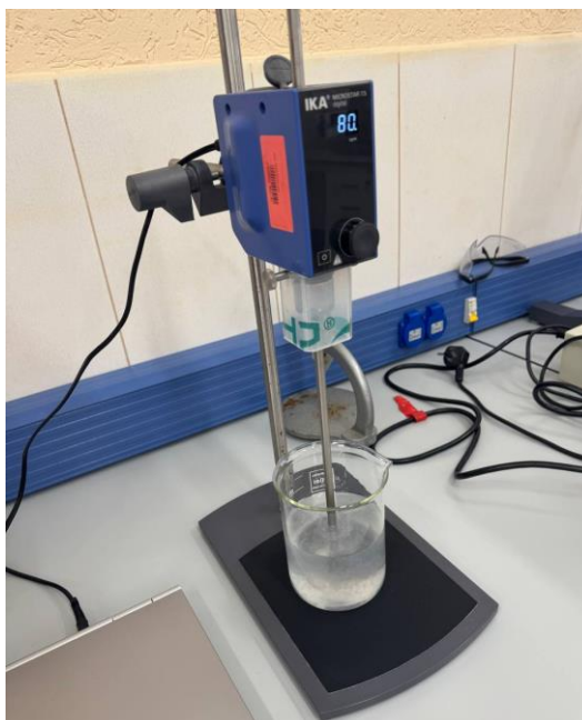
Рисунок 15 – Внешний вид верхнеприводной мешалки для приготовления полимерных составов (фото автора)
