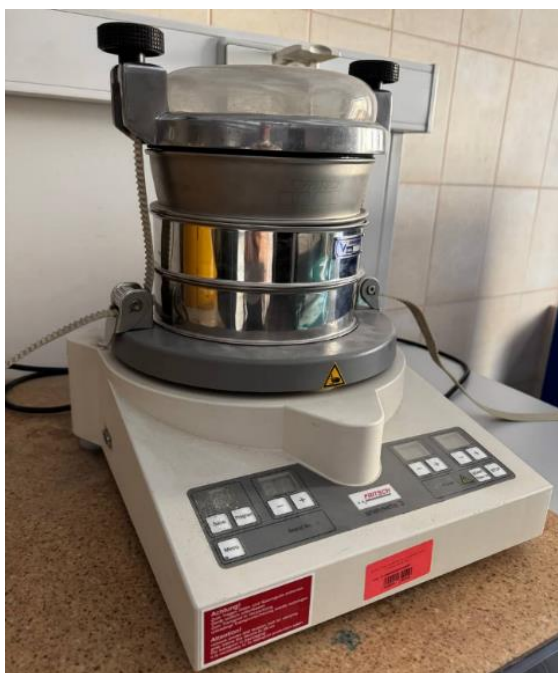
Рисунок 17 – Внешний вид вибростенда с набором сит (фото автора)
