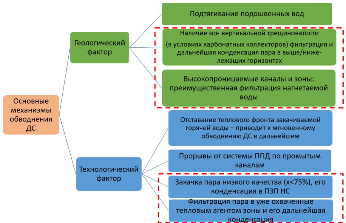
Рисунок 10 – Механизмы обводнения добывающих скважин, дренирующих продуктивные пласты на глубине >800 м (красной пунктирной линией отмечены механизмы неэффективного использования пара) (составлено автором)
