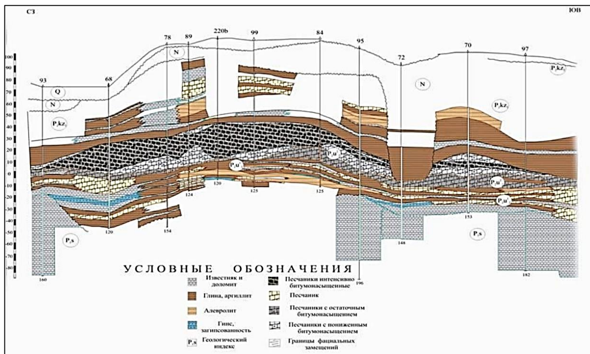
Рисунок 14 – Геологический профиль Ашалчинского месторождения [40]
