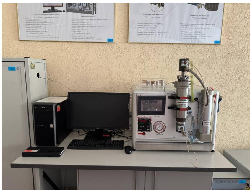
Рисунок 27 – Внешний вид пермеаметра-порозиметра «ПИК ПП» (фото автора)
