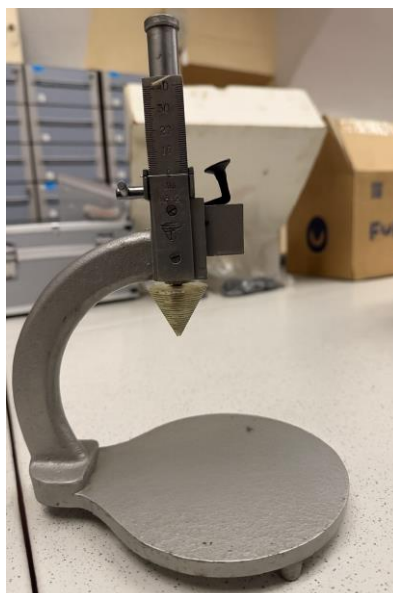
Рисунок 19 – Внешний вид пластомера Ребиндера (фото автора)
