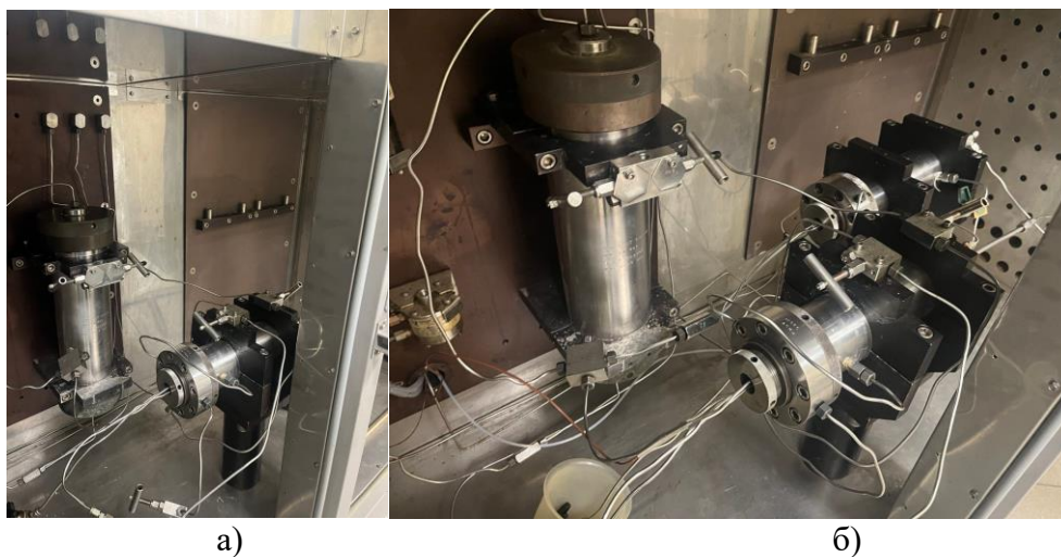
Рисунок 24 – Общий вид фильтрационной установки RPS-812. а) определение остаточного фактора сопротивления на однородной модели керна; б) определение коэффициента вытеснения на модели неоднородного пласта (фото автора)
