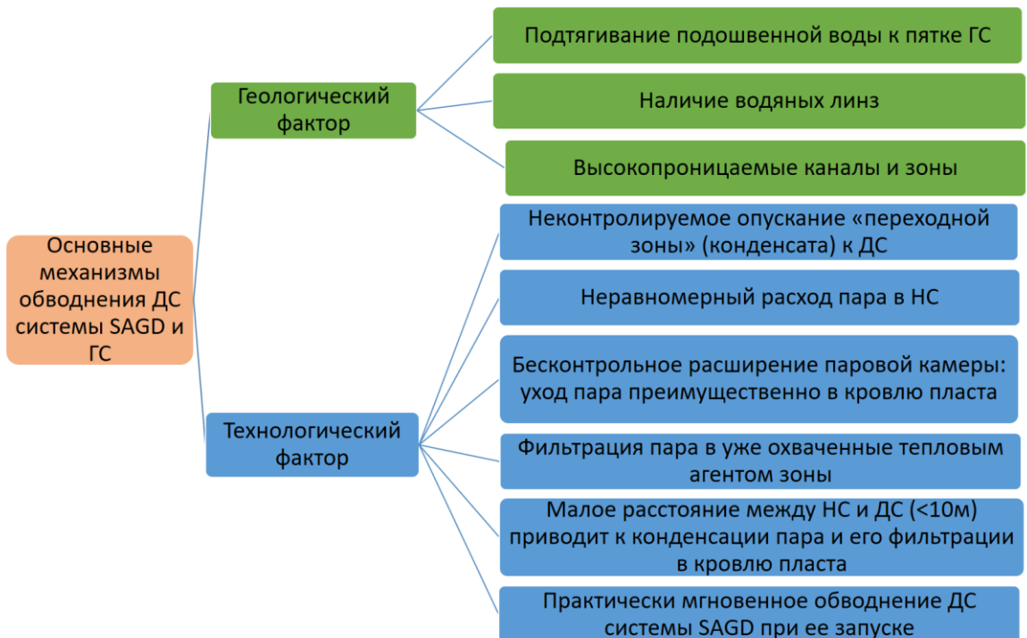
Рисунок 11 – Механизмы обводнения добывающих скважин, дренирующих продуктивные пласты на глубине <800 м (составлено автором)
