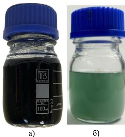
Рисунок 31 – Внешний вид разработанного полимерного состава на основе 5 мас. % поливинилового спирта (фото автора):
