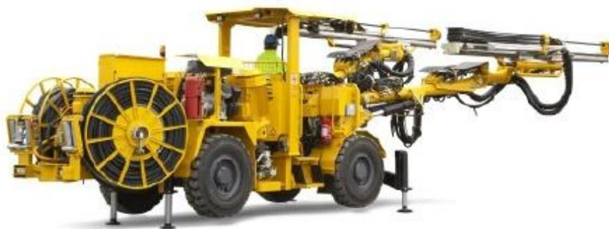
Рисунок 4.1 – Буровая установка Atlas Copco Boomer 282 (составлено автором)
