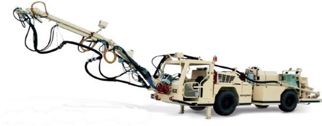
Рисунок 4.7 – Установка для крепления набрызбетоном Spraymec 6050WP
