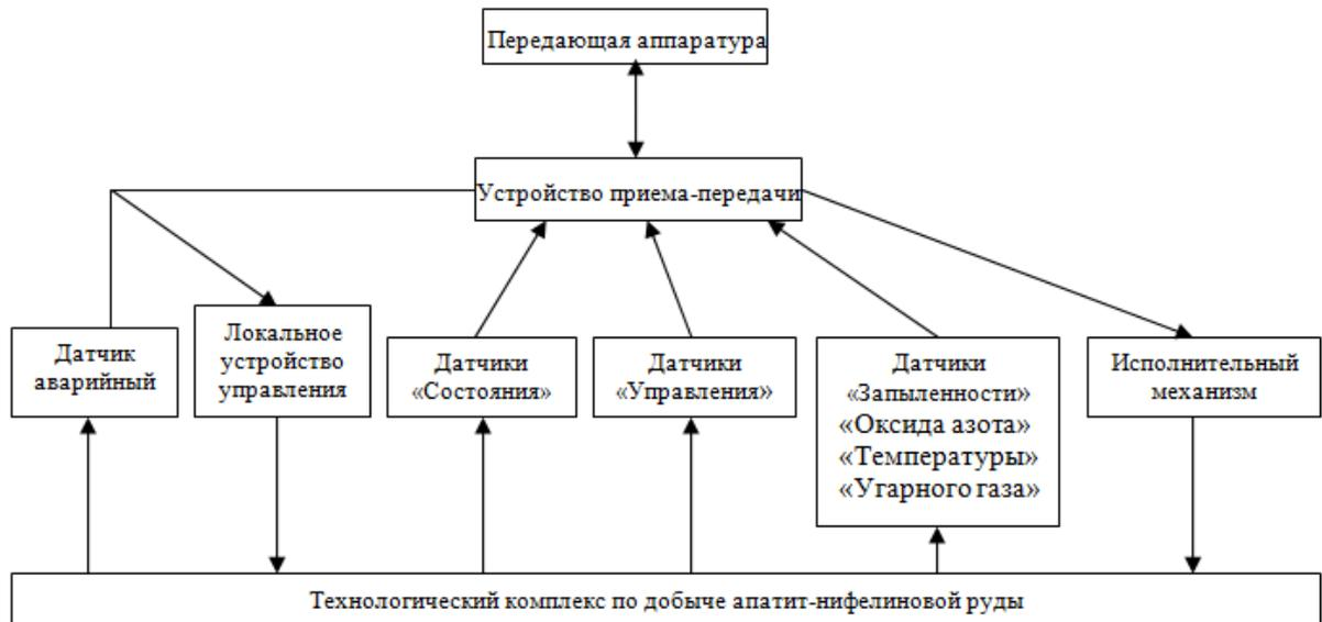
Рисунок 2.3 – Концептуальная модель системы управления технологическим процессом эксплуатации Кировского рудника АО «Апатит» (составлено автором)
