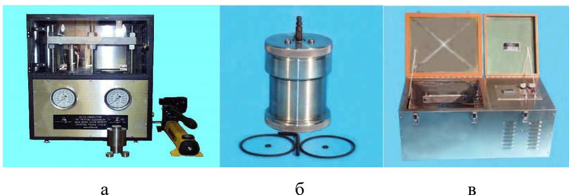
Рисунок 4 - Комплект оборудования для исследования на эрозионную устойчивость (компактор (а), ячейка термостарения (б), вальцовая печь (в))
