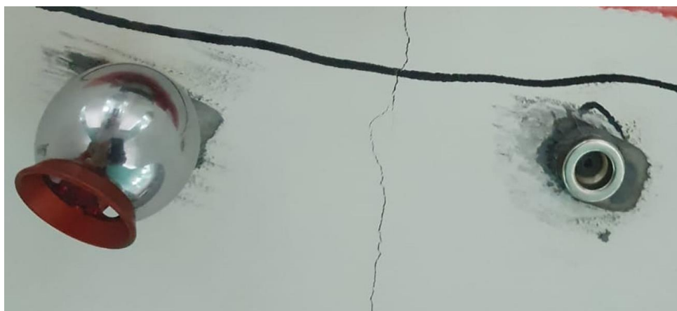
Рисунок 4.5 – Пример установки визирной цели на пункты, закрепленные для контроля локальных деформаций (фото автора)
