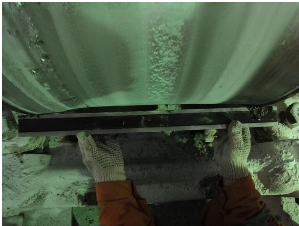
Рисунок 1.4 – Видимый износ оборудования вследствие ненадлежащего контроля геометрии (фото автора)
