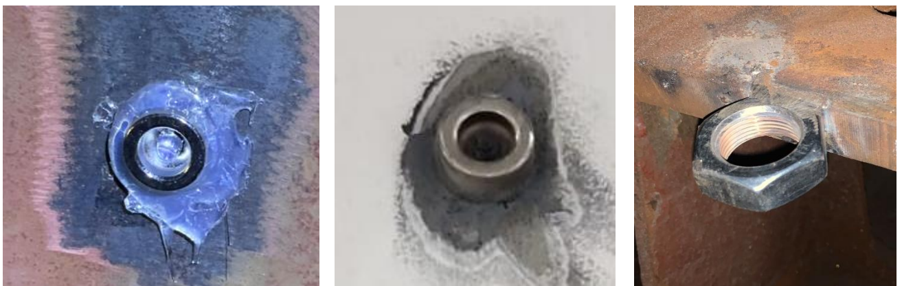
Рисунок 1.12 – Типы закрепления пунктов для установки сферических визирных целей [58]
