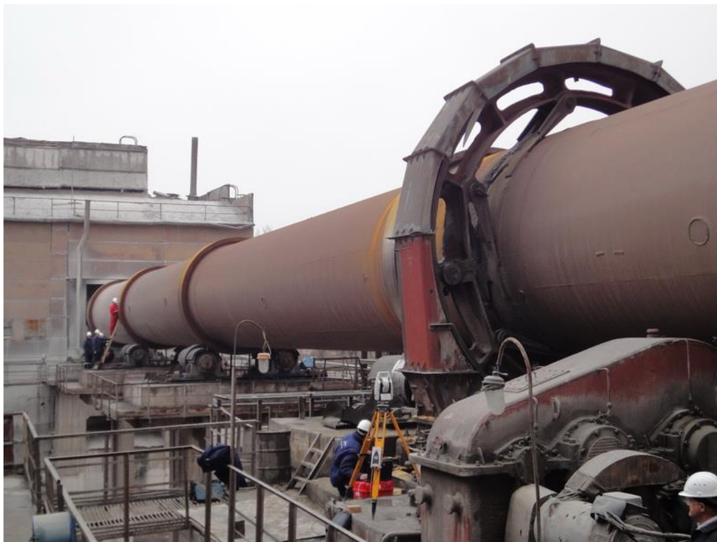
Рисунок 1.3 – Контроль геометрии вращающихся печей с использованием лазерного трекера (фото автора)
