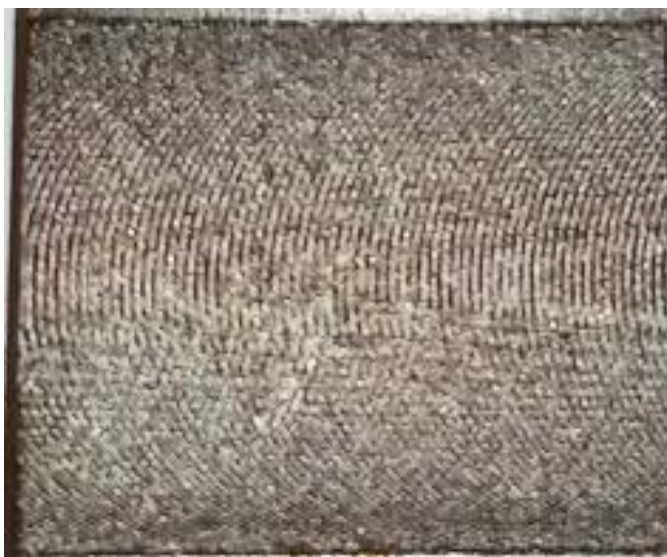
Рисунок 3.3 – Поверхность образца, обработанная на непрерывном лазере, х5 [фото автора]
