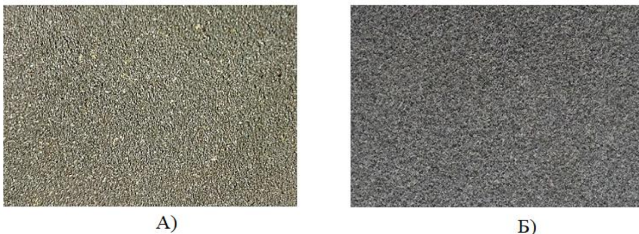
Рисунок 2.1 – Поверхность металлической трубы после: А) дробеструйной обработки; Б) пескоструйной обработки, х5 [фото автора]
