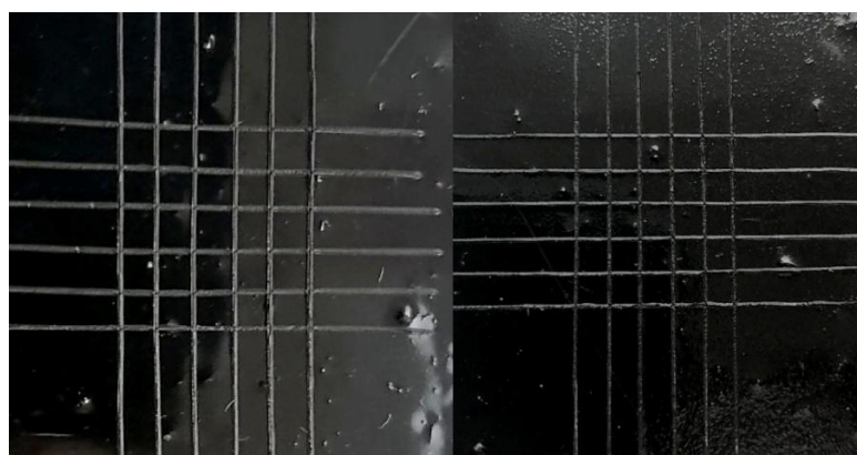
Рисунок 3.16 – Решетка надрезов при испытании покрытия на адгезию образца с эпоксидной эмалью с промежуточным фосфатным слоем (справа) и без него (слева) [фото автора]
