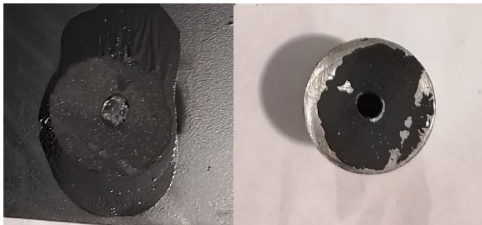
Рисунок 3.18 – Когезионный отрыв в фосфатном слое, х2 [фото автора]
