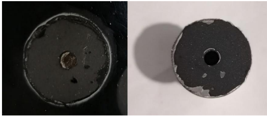
Рисунок 3.17 – Зона отрыва грибка между эпоксидной эмалью и чистой металлической подложной после лазерной обработки, цианокрилатный клей, х2 [фото автора]
