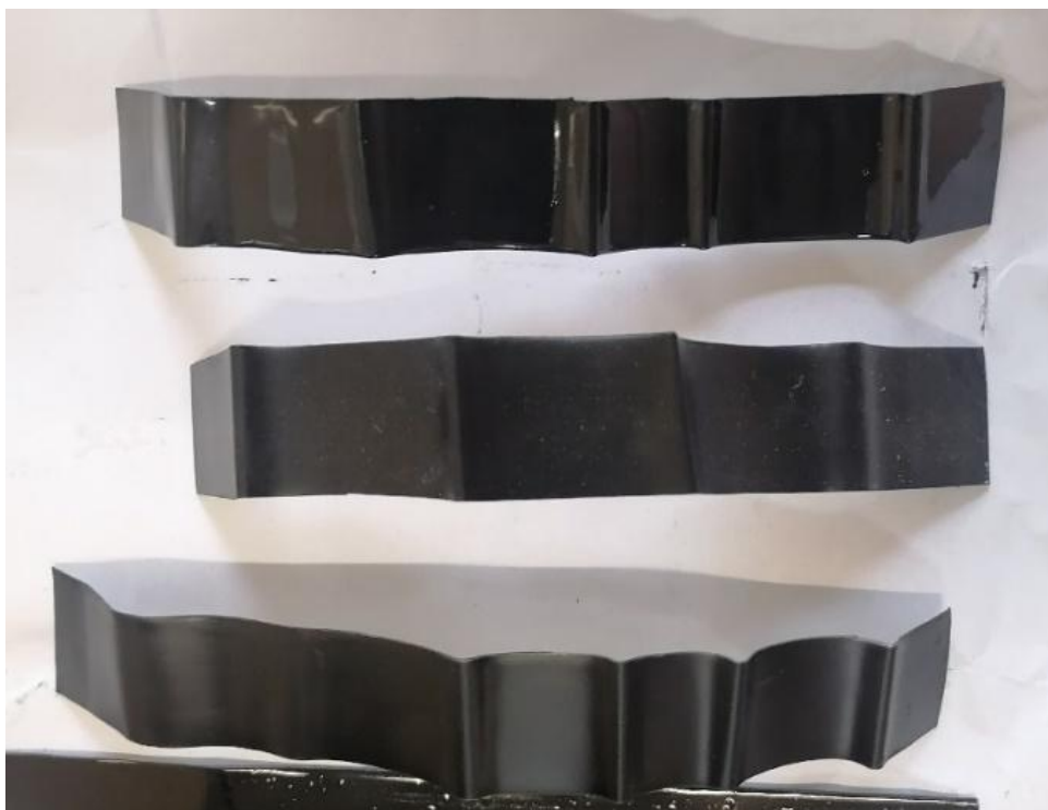
Рисунок 4.3 – Жестяные пластинки с эпоксидной (верхняя) и полиуретановой (средняя и нижняя) после испытаний [фото автора]
