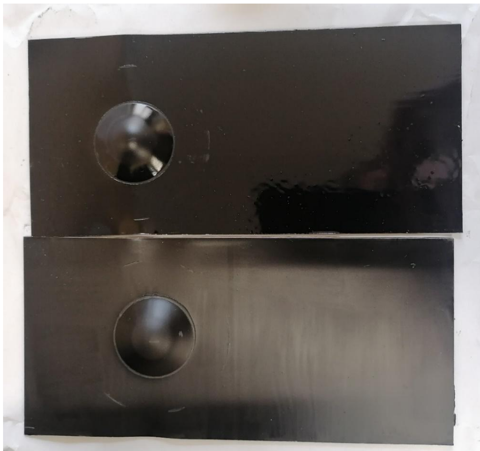
Рисунок 4.5 – Образцы после вдавливания матрицы с эпоксидной (сверху) и полиуретановой (снизу) эмалями [фото автора]
