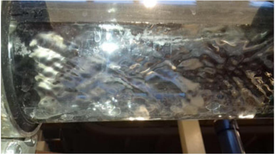
Рисунок 2.6 – Интенсивное волнообразование на поверхности перекачиваемой жидкости экспериментального стенда [111]
