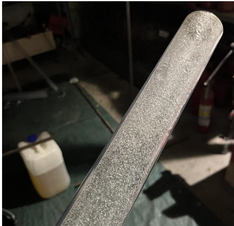
Рисунок 3.10 – Сменная трубная секция самотечного участка трубопровода экспериментального стенда с шероховатостью 0,4 мм (фото автора)
