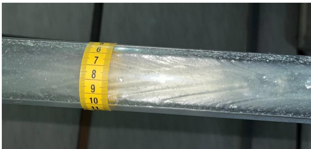
Рисунок 3.11 – Волны на поверхности перекачиваемого дизельного топлива на самотечном участке экспериментального стенда, (фото снизу) (фото автора)
