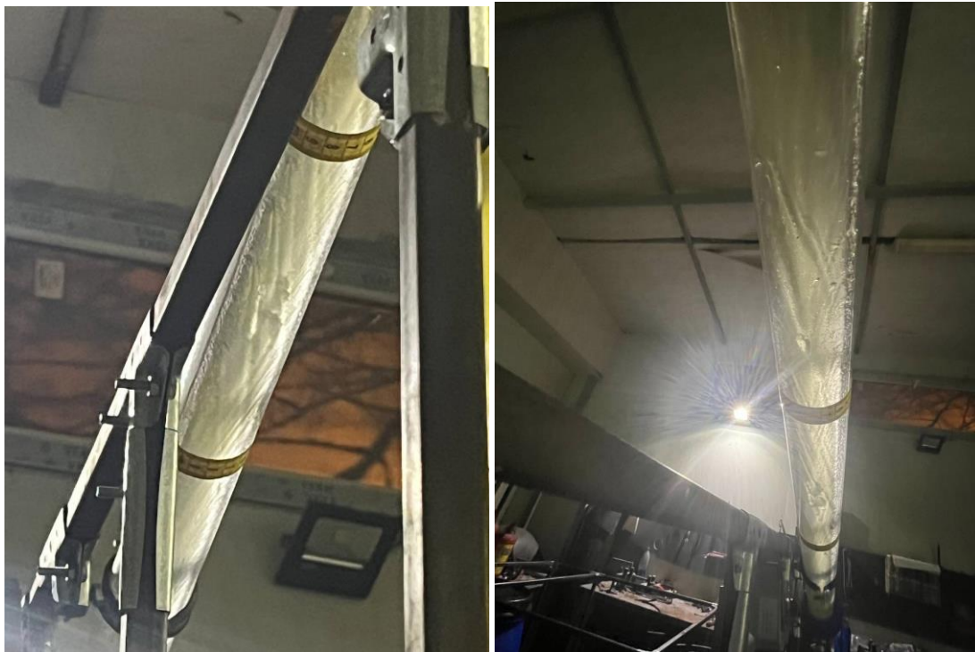
Рисунок 3.12 – Волны на поверхности перекачиваемого дизельного топлива на самотечном участке экспериментального стенда, (фото снизу) (фото автора)
