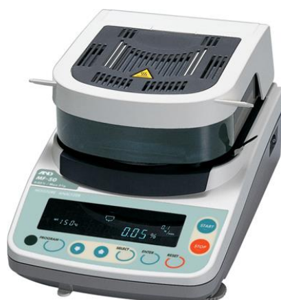
Рисунок 28 – Анализатор влажности AND MF-50 (фото автора)
