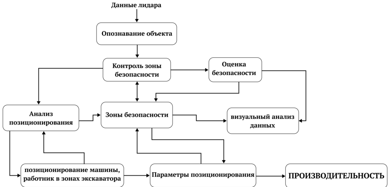
Рисунок 45 — Алгоритм управления позиционированием экскаватора в рабочей зоне [155, 65]
