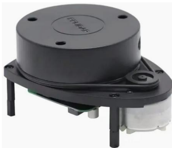
Рисунок Г.1 – Общий вид сенсора LiDAR (RPLIDAR A1M8) [190]
