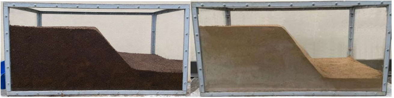
Рисунок 29 – Схема моделирования с использованным натуральных материалов с коэффициентом подобия 1:1 (фото автора)
