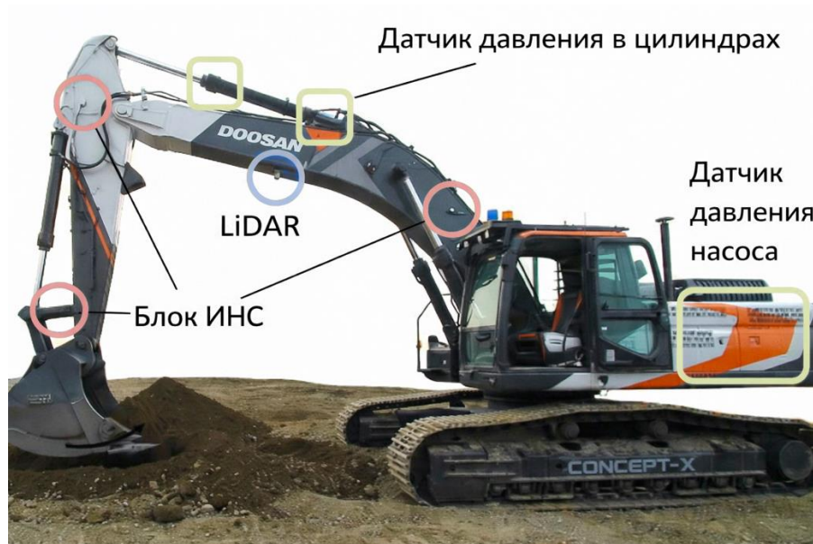
Рисунок 20 – Схема размещения LiDAR-сенсора на стреле/рукояти гидравлического экскаватора [141]
