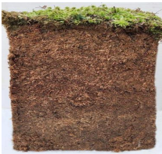
Рисунок 23 – Образец ненарушенного материала из верхнего слоя торфяной залежи (фото автора)
