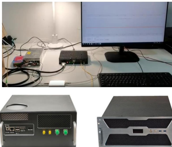
Рисунок 3.5 – Общий вид оборудования и лабораторного стенда для регистрации сигналов (составлено автором)
