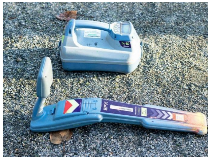
Рисунок 1.3 – Электромагнитный локатор производства GeoScan (Канада) [51]
