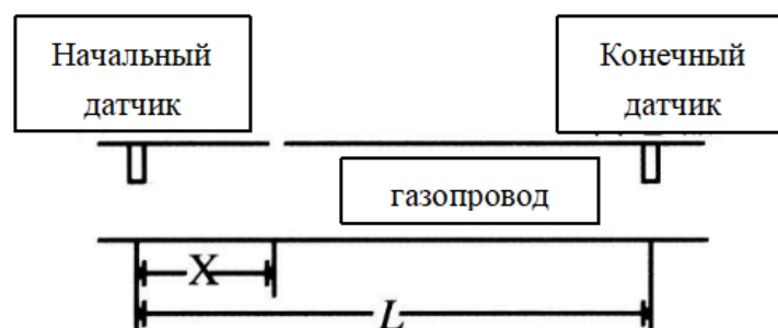
Рисунок 1.7 – Принципиальная схема обнаружения утечек волной отрицательного давления [25]
