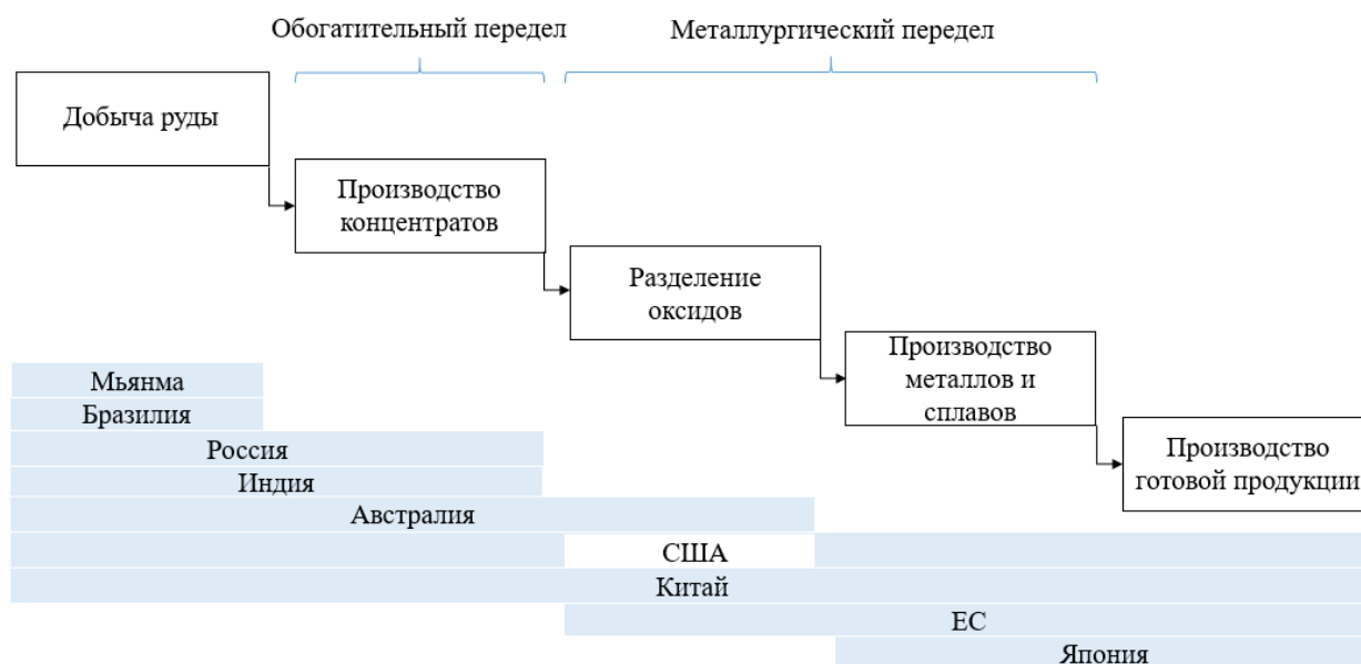
Рисунок 1 – Полная технологическая цепочка создания РЗМ-продукции [10]
