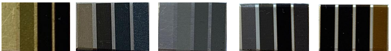
Рисунок 2.11 - Фото образцов из изучаемых металлов и сплавов с нанесенными с помощью лазера цветные (серо-черные) полосы, полученные при разных значениях параметров лазерной обработки [составлено автором]
