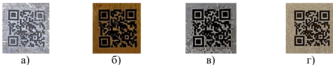
Рисунок 4.5 - Примеры нанесения кода 5x5 мм на поверхности исследуемых материалов при оптимальных режимах лазерной обработки:
