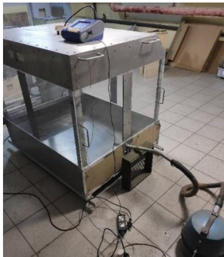
Рисунок 2.6 – Внешний вид пылевой камеры (фото автора)
