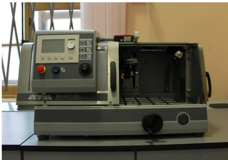
Рисунок 3.3 - Установка точной резки ATM Brillant 220 (фото автора)
