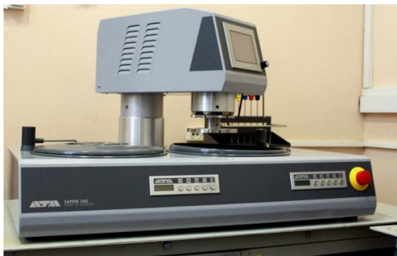
Рисунок 3.7 - Установка для шлифподготовки и полировки ATM Saphir 560 (фото автора)
