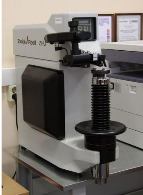
Рисунок 3.18 - Универсальный твердомер Zwick/Roell тип 8187,5 LKV (фото автора)
