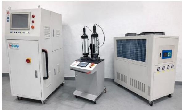
Рисунок 3.11 - Установка плазменного напыления Shanghai Biapu Technology Co, BP-5000 (фото автора)
