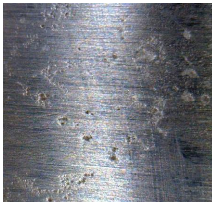
Рисунок 1.14 - Микротрещины, вмятины и выемки на поверхности (фото автора)
