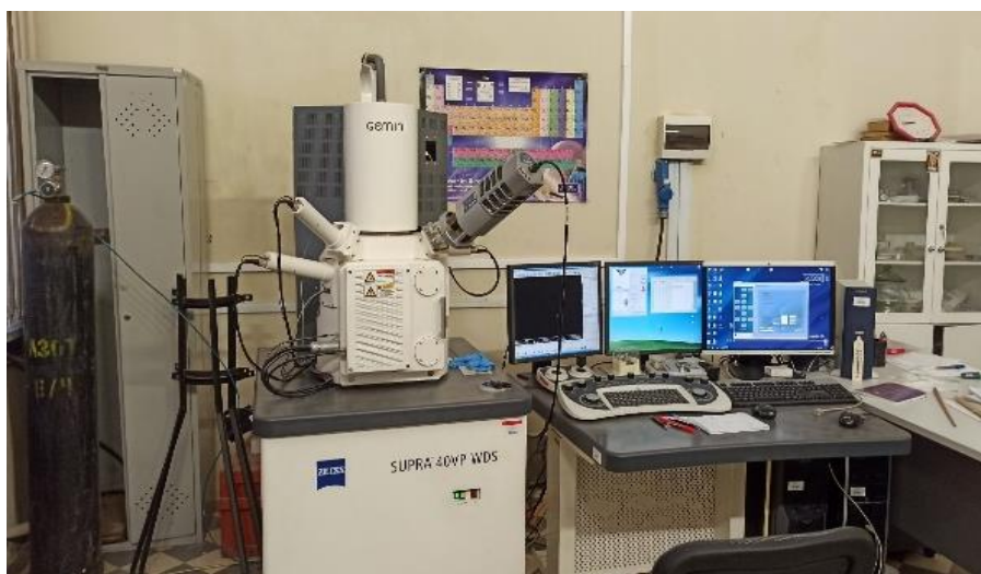
Рисунок 3.23 - Supra 40VP Carl Zeiss (фото автора)
