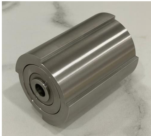
Рисунок 4.17 - Валок с сегментированными футеровочными бандажами (фото автора)
