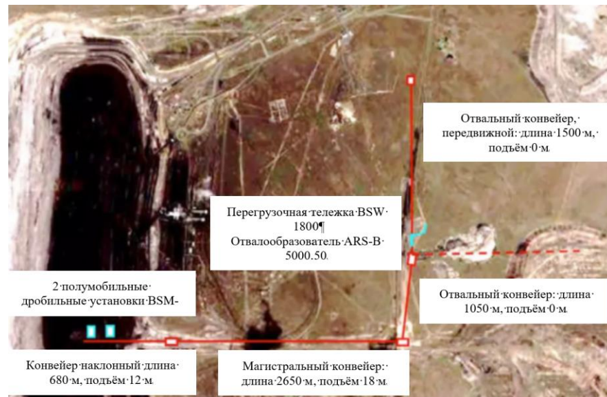
Рисунок 1.2 - Схема циклично-поточного вскрышного комплекса на разрезе «Восточный» (полумобильная дробилка, конвейерный подъём, перевалочный мост и отвалообразователь) [144]
