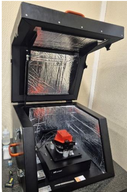
Рисунок 3.21 - Nanosurf Flex AFM (фото автора)
