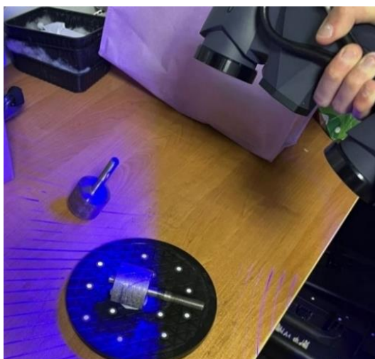
Рисунок 3.31 - Процесс сканирования валка 3D сканером AltaScan (фото автора)
