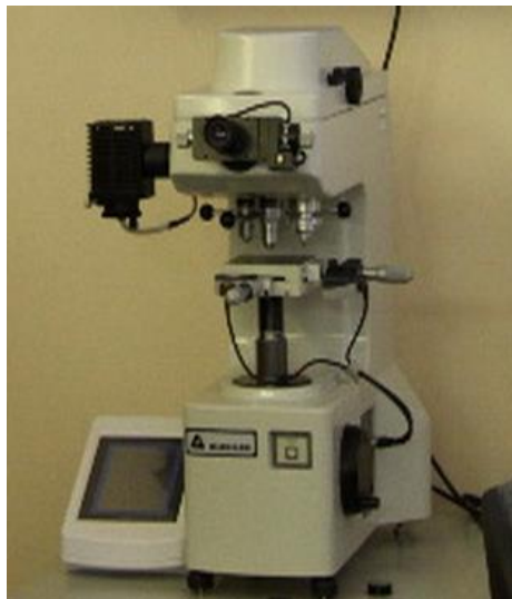
Рисунок 3.19 - Микротвердомер Buehler Micromet 5103 (фото автора)
