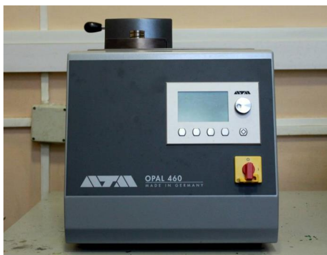
Рисунок 3.6 - Установка для запрессовки ATM Opal 460 (фото автора)
