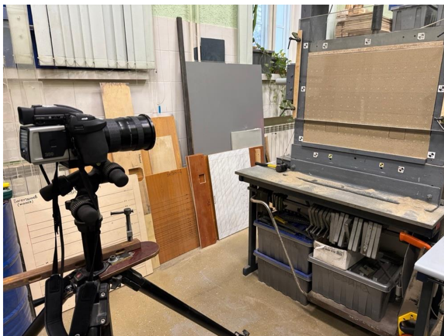
Рисунок 3.5 – Физическая модель из эквивалентных материалов и применяемое оборудование для фотофиксации смещений (общий вид) (фото автора)
