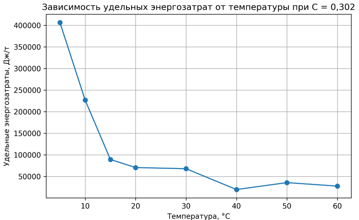
Рисунок 4.7 – Зависимость удельных энергозатрат на транспортировку смеси нефти Северо-Комсомольского и Ванкорского месторождений от температуры при C=0,302 (составлено автором)
