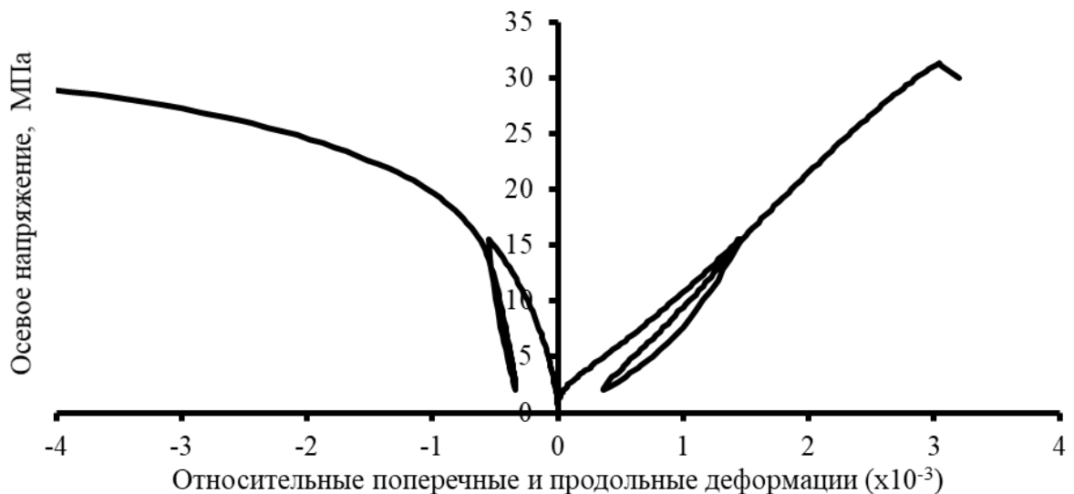
Рисунок 3.14 – Прочностные и деформационные характеристики образца песчаника, профильтрованного водой [66]
