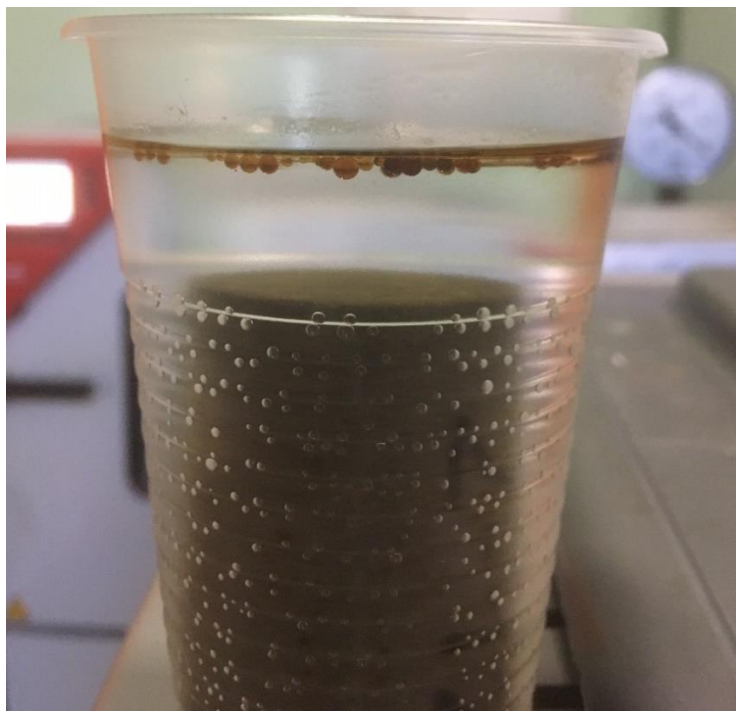
Рисунок 2.4 – Экстрагирование образцов керна (фото автора)
