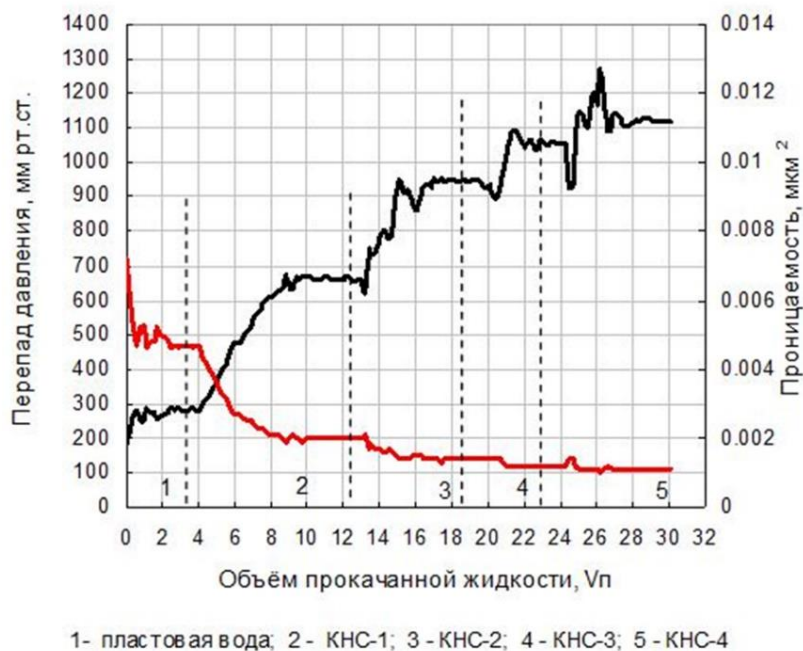
Рисунок 1.23 – Динамика фильтрации различных вод через образец Тарасовского месторождения [34]
