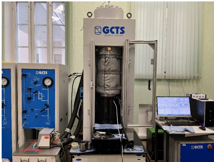
Рисунок 2.17 – Сервогидравлическая система RTR 1500 (фото автора)
