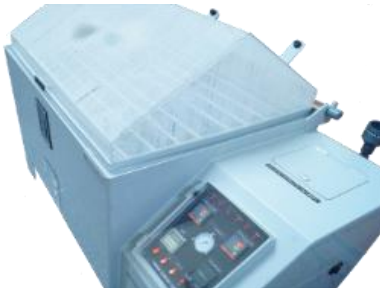
Рисунок 2.8 – Камера соляного тумана [фото автора]
