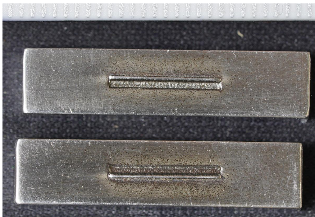
Рисунок 5.2 – Образцы после выдержки в кислом соляном тумане в течение 240 ч [фото автора]
