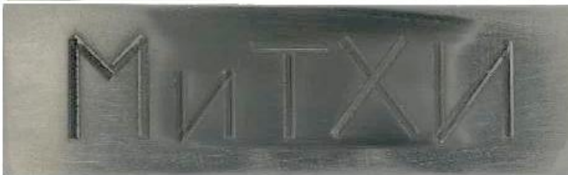
Рисунок 5.6 – Зона износа после 100 оборотов колеса [составлено автором]
