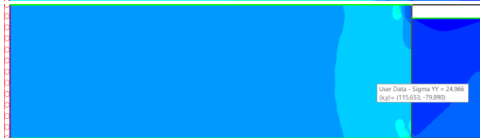
Рисунок 16 - Поле вертикальных напряжений в краевой части опорного целика (составлено автором)
