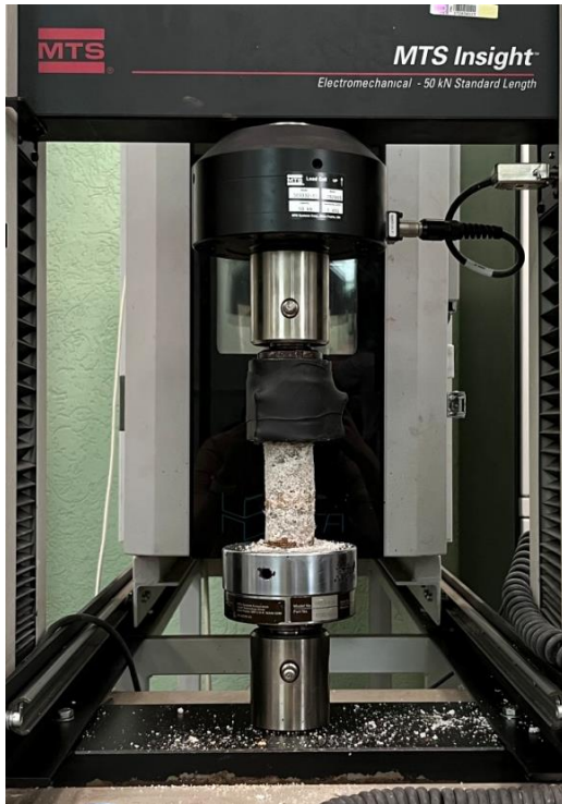
Рисунок 20 – Лабораторные испытания образцов закладки:
