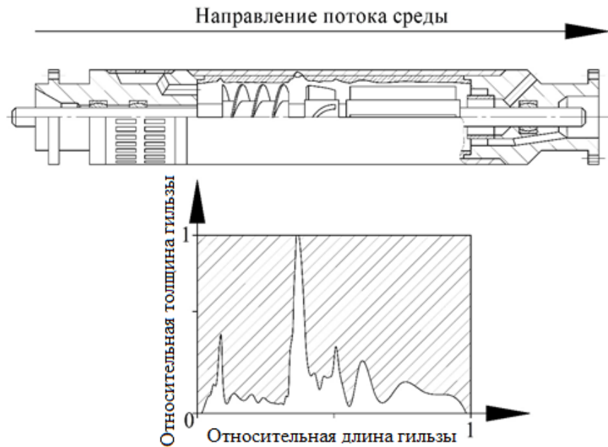
Рисунок 11 – Изменение интенсивности изнашивания по длине защитной гильзы центробежного газосепаратора конструкции П.Д. Ляпкина
