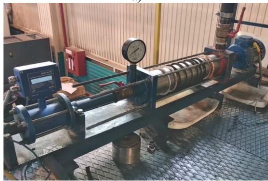
Рисунок 3 – Схема (а) и общий вид (б) лабораторного стенда для исследования процесса гидроабразивного изнашивания рабочих ступеней ЭЦН
