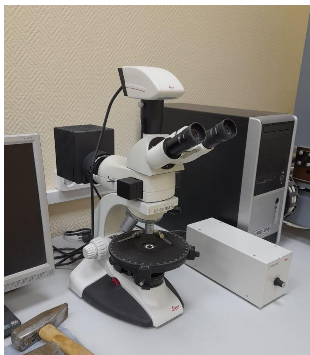
Рисунок 3.7 – Микроскоп для оптической оценки гранулометрического состава и формы частиц механических примесей
