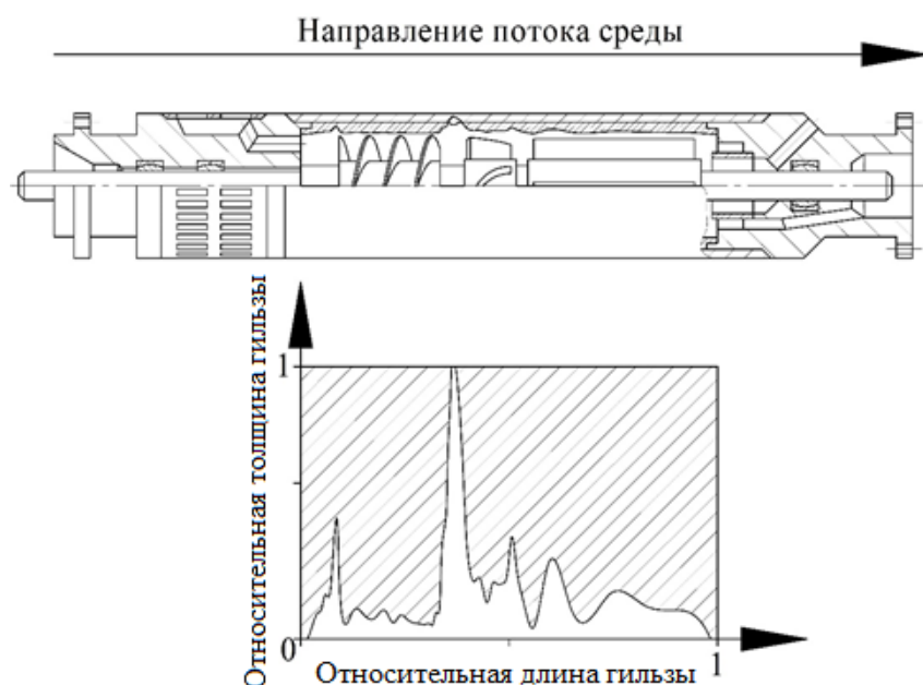
Рисунок 4.7 – Изменение интенсивности изнашивания по длине защитной гильзы центробежного газосепаратора конструкции П.Д. Ляпкина
