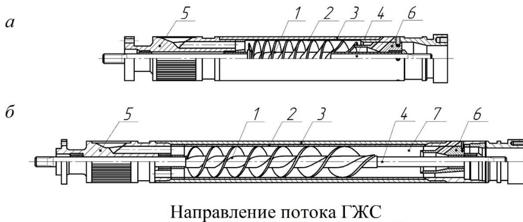
Рисунок 2.10 – Абразивостойкие газосепараторы УЭЦН производства АО «Новомет-Пермь»: a – центробежный; б – вихревой; 1 – шнек; 2 – защитная гильза; 3 – корпус; 4 – приводной вал; 5 – входной модуль; 6 – модуль-разделитель; 7 – вихревая камера
