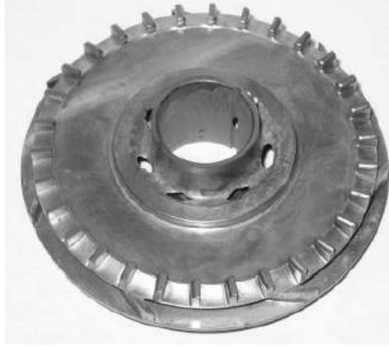
Рисунок 2.5 – Состояние ступени ВНН5А-100 по истечении 7 часов испытаний при перекачке гидроабразивной смеси с концентрацией механических примесей C=10 г/л с частотой вращения приводного вала n = 6000 об/мин
