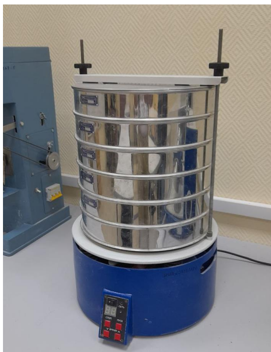
Рисунок 3.6 – Комплект сит и вибромашина для подготовки модельных механических примесей
