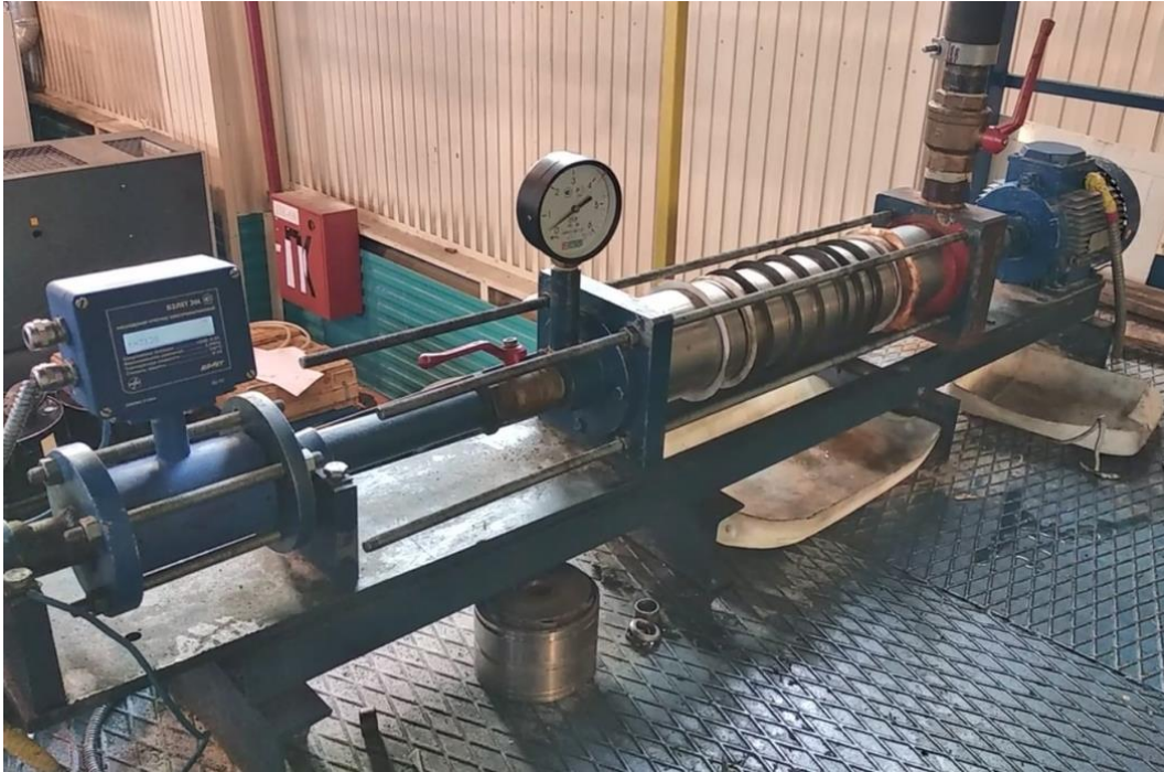
Рисунок 3.2 – Общий вид лабораторного стенда для исследования процесса гидроабразивного изнашивания рабочих ступеней ЭЦН
