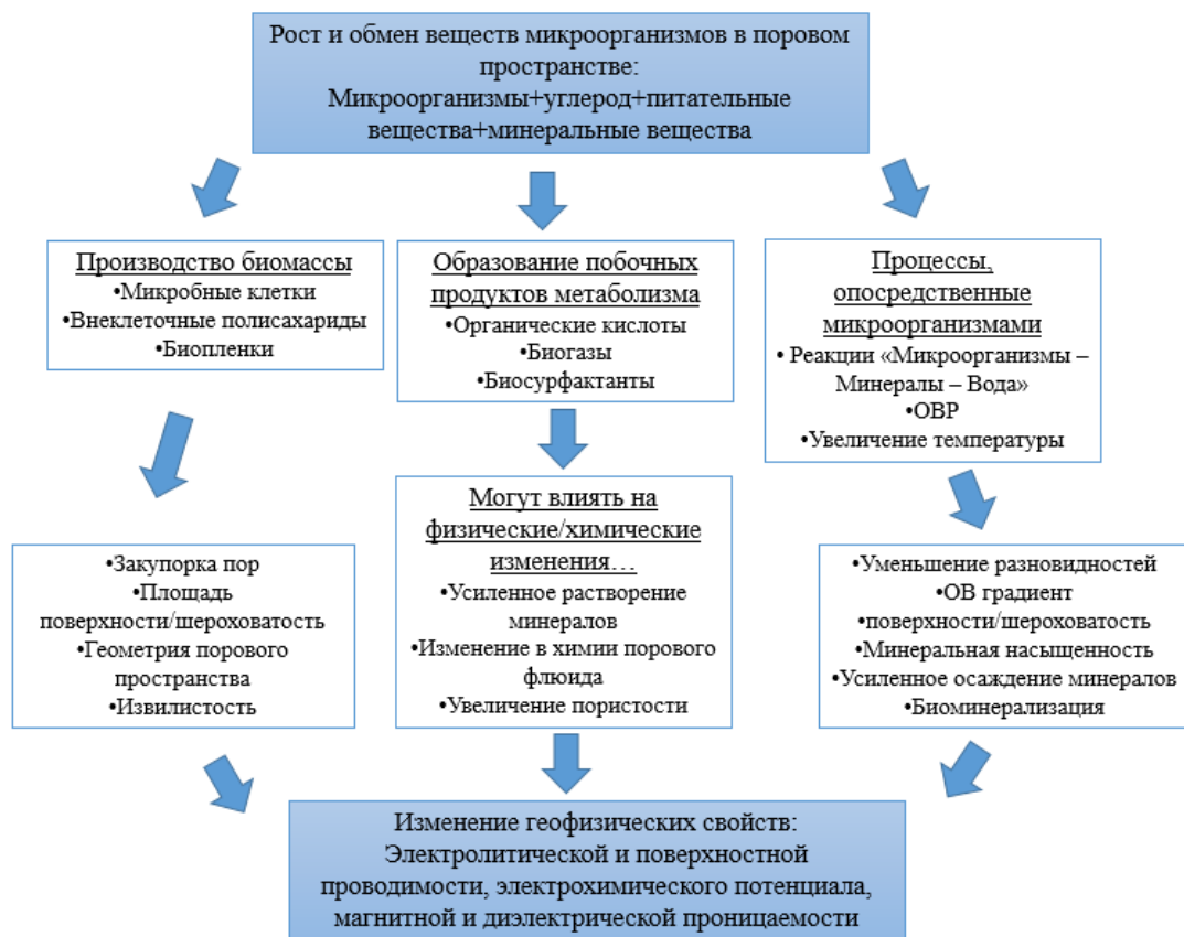
Рисунок 1.5 – Обобщенная диаграмма, демонстрирующая влияние микробного роста и микробной активности на физико-химические свойства грунтов и измеряемые геофизические параметры (адаптация данных [46])
