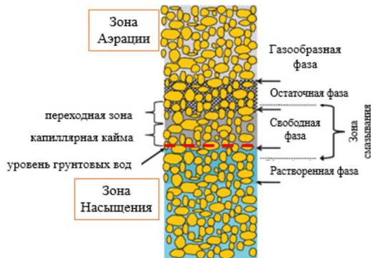
Рисунок 1.1 – Схема распределения воды и различных фаз легкой безводной жидкости (LNAPL) в грунтах, загрязненных нефтепродуктами. Красным пунктиром показана граница между зоной аэрации и зоной полного водонасыщения (адаптация данных [46])
