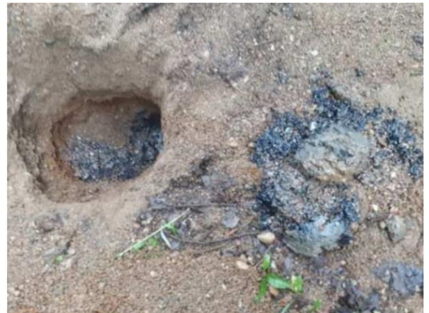
Рисунок 3.21 – Фото нефтяного загрязнения участка: слева – шурф с прослойкой нефтезагрязнения (битум/мазут) на глубине около 20 см; справа – шурф с нефтезагрязнением на глубине около 50 см, засыпанный песком с гравием (фото автора)
