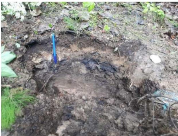
Рисунок 3.21 – Фото нефтяного загрязнения участка: слева – шурф с прослойкой нефтезагрязнения (битум/мазут) на глубине около 20 см; справа – шурф с нефтезагрязнением на глубине около 50 см, засыпанный песком с гравием (фото автора)
