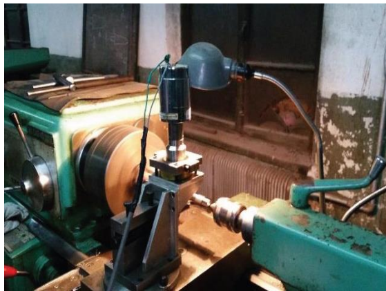
Рисунок 1.1 – Экспериментальная установка: (а) структурная схема ультразвуковой вибрационной системы, (б) система ультразвуковой вибрационной токарной обработки и (в) система трехмерного отображения сверхглубины резкости типа VHX-1000E [94]
