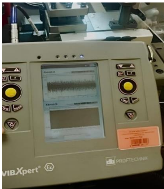
Рисунок 3.12 – Установление двухканального виброанализатора модели VIBXpert EX при механической обработке деталей типа «тел вращения» из стали марки 08X18H10T (фото автора)
