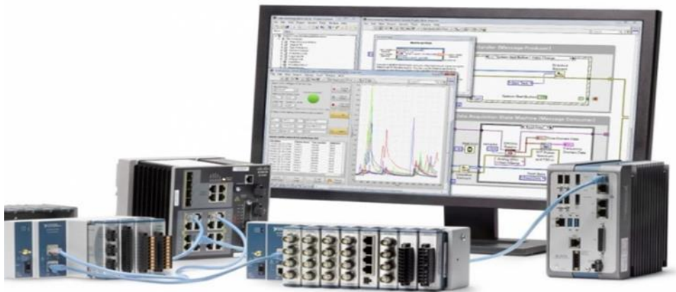
Рисунок 3.2 – Измерительный прибор NI CompactRIO, соединённый с персональным компьютером с установленной средой LabVIEW для приема и обработки значения собственных затухающих колебаний (фото автора)
