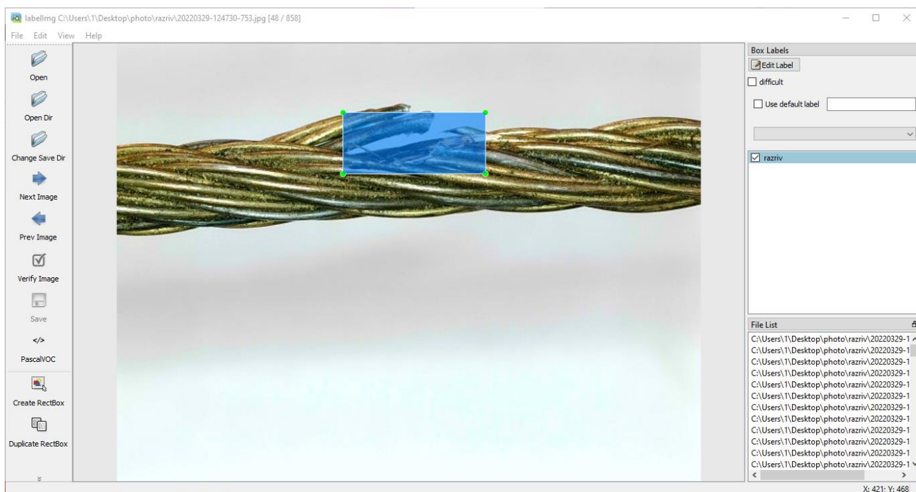
Рисунок 2.4 – Разметка дефектов в ПО LabelImg (составлено автором)
