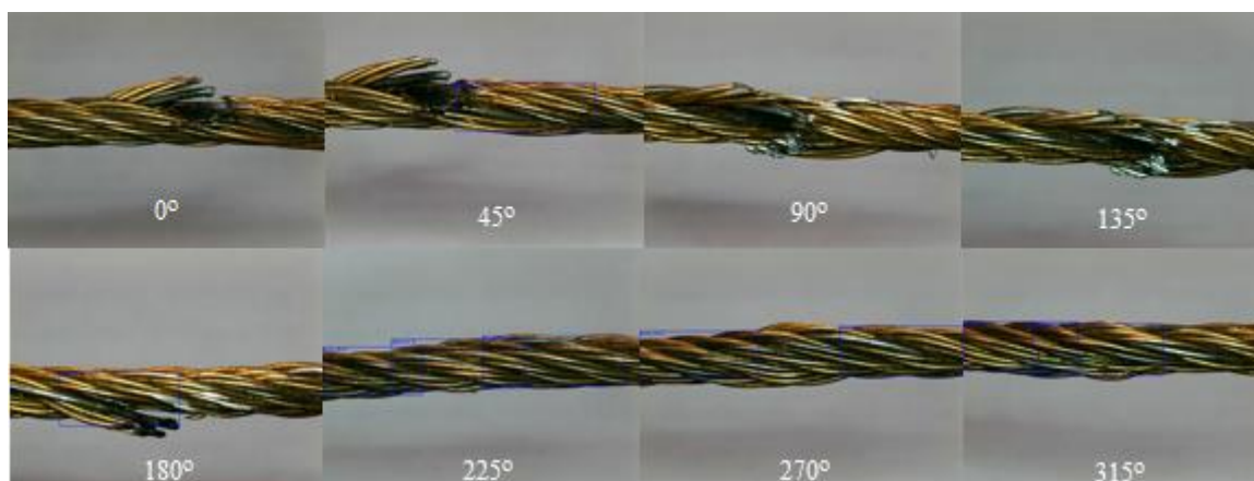
Рисунок 2.8 – Изображения дефект разрыв (составлено автором)
