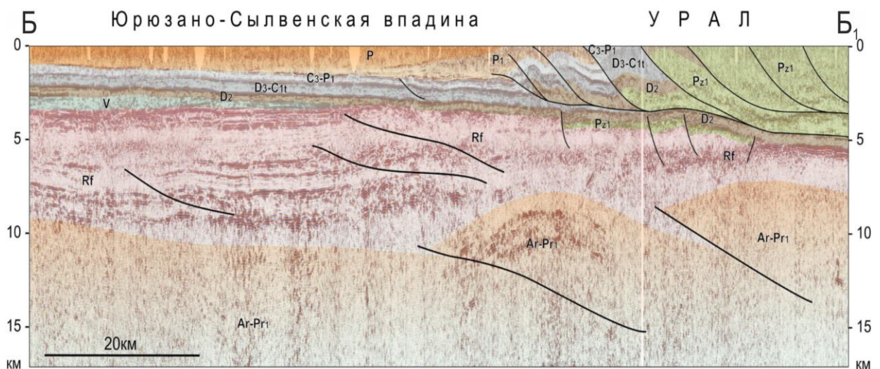
Рисунок 6 – Геолого-геофизический разрез через Уральскую краевую систему по линии Б - Б 1 [160]
