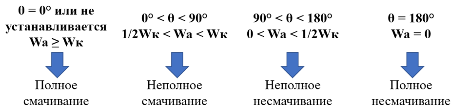
Рисунок 3.6 – Возможные варианты смачивания поверхности (составлено автором)
