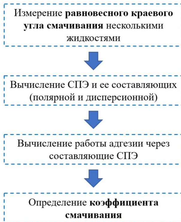
Рисунок 3.12 – Алгоритм проведения подхода к оценке поверхностных свойств при применении депрессоров (составлено автором)
