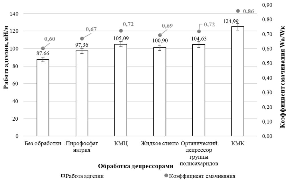
Рисунок 3.20 – Графическая зависимость изменения работы адгезии при применении депрессоров для угля марки К (составлено автором)
