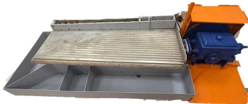
Рисунок 2.9 – Лабораторный концентрационный стол (фото автора)
