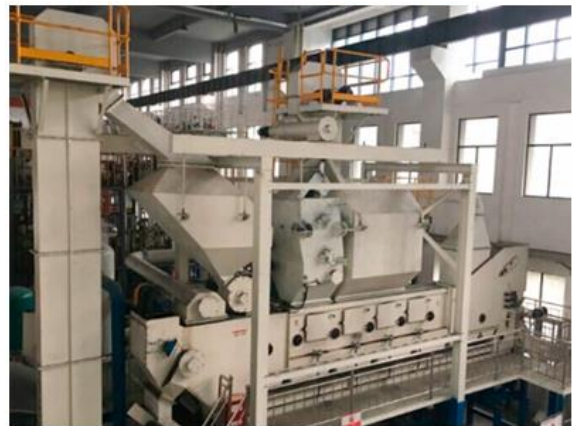
Рисунок 1.5. – Принципиальная схема сухого обогащения угля в системе кипящего слоя плотной воздушной среды (ADMFB) и ее полупромышленная система [119]
