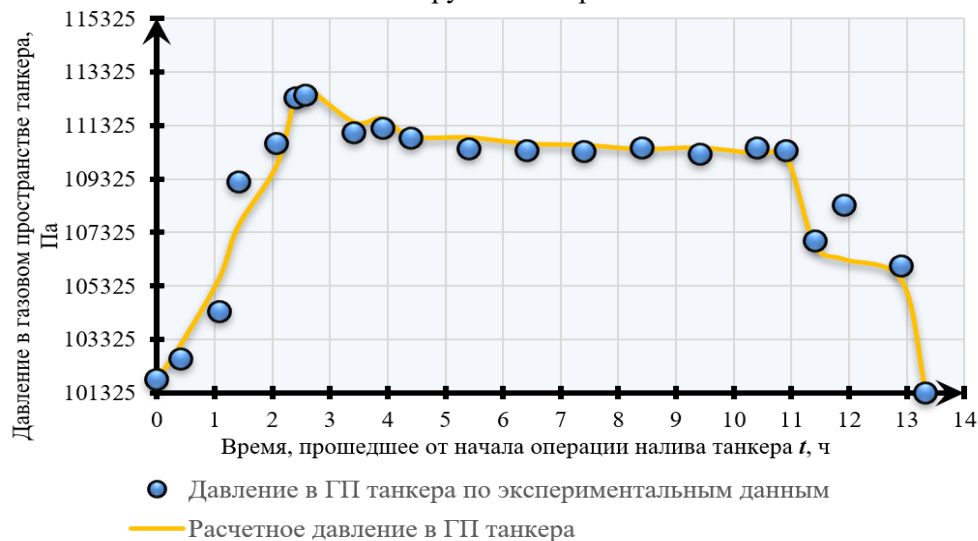
Рисунок 4 – График сопоставления результатов моделирования динамики роста давления в газовом пространстве танкера с экспериментальными данными
