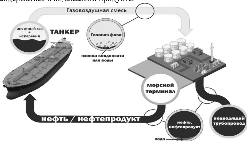
Рисунок 5 – Условная схема движения потоков жидкой и газовой фазы при выполнении товарно-транспортных операций при погрузке танкеров
