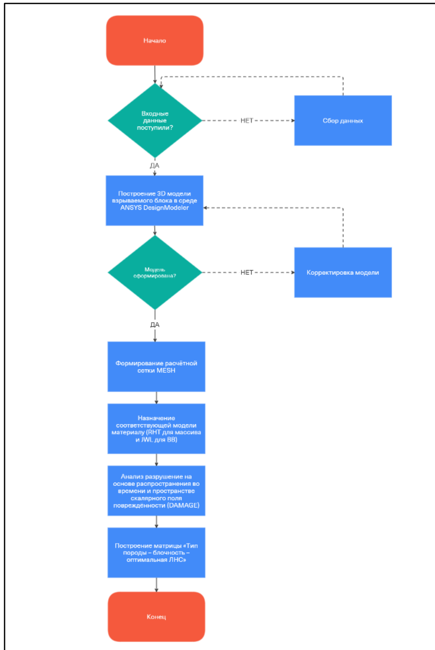
Рисунок 3.1 – Концептуальная схема реализации численного моделирования
