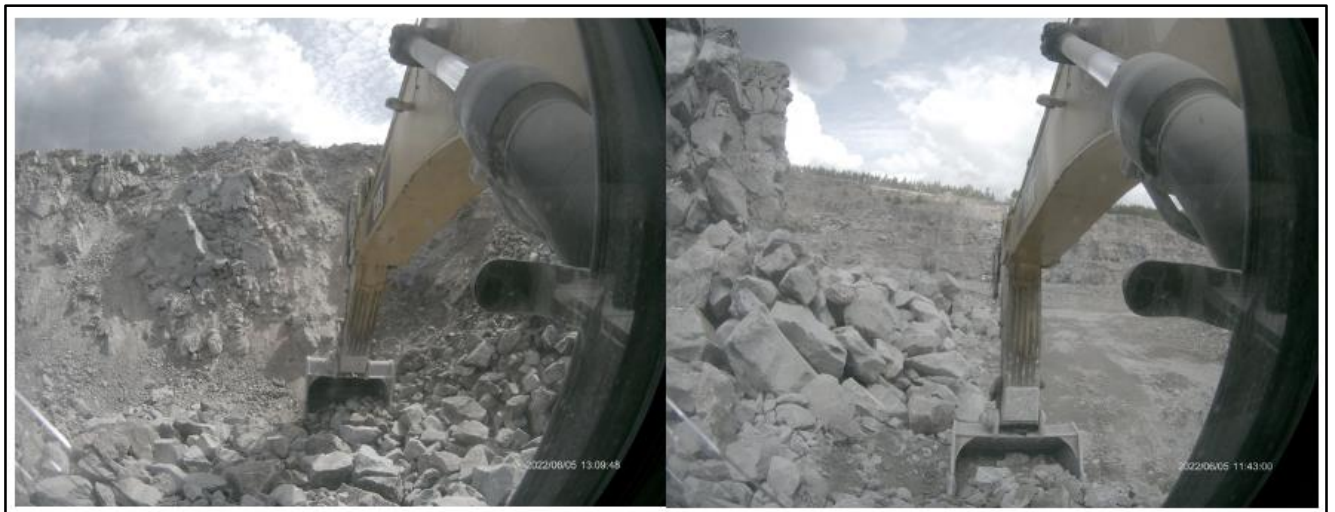
Рисунок 4.8 - Развал буровзрывного блока №4
