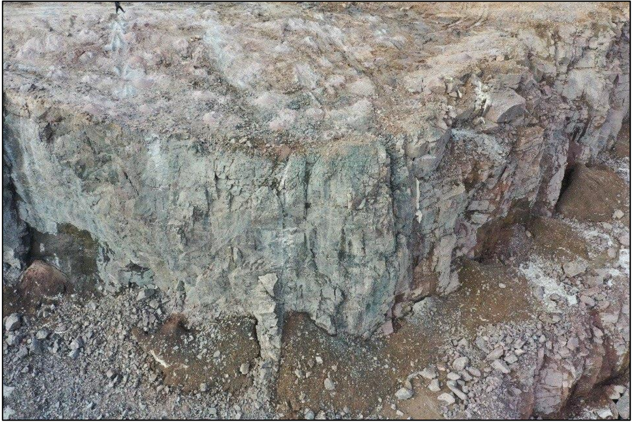
Рисунок 4.3 - Съемка откоса уступа при помощи БПЛА DJI Mavic Pro 2
