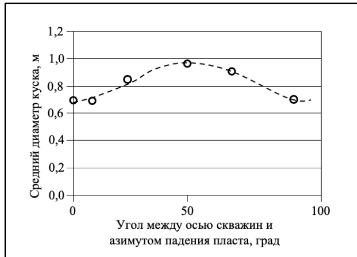
Рисунок 1.4 - Изменение размера куска на поверхности развала в зависимости от угла встречи скважинного заряда с напластованиями массива [25]
