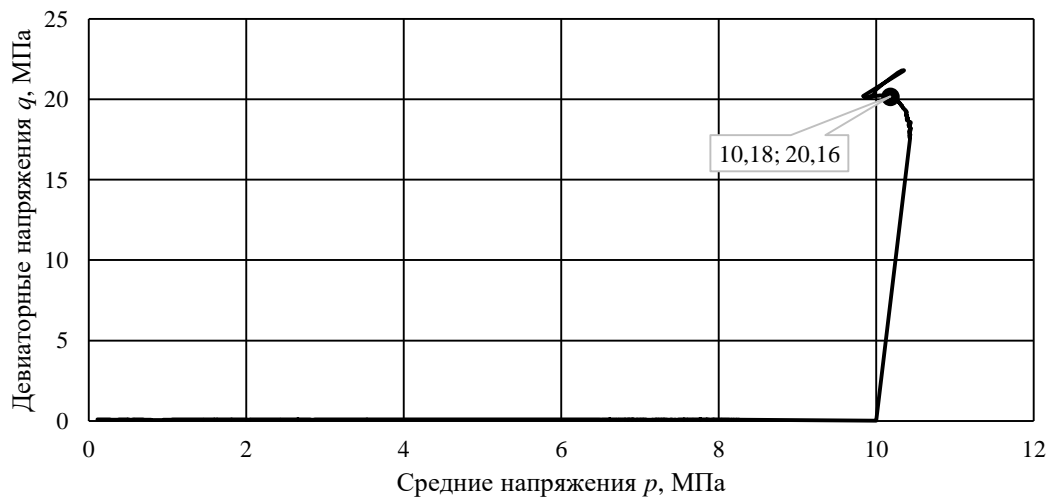
Рисунок 18 – Пример графика зависимости девиаторных напряжений q при выдержке постоянного значения средних напряжений p=10,0 МПа (составлено автором)
