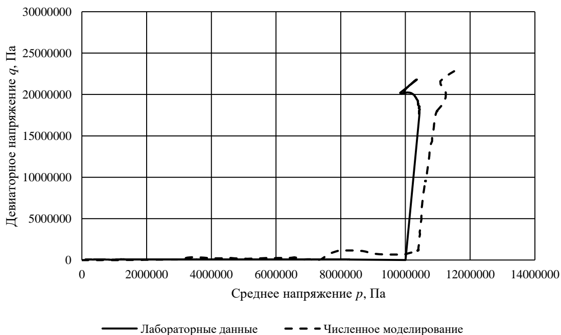
Рисунок 67 – Сравнение зависимости q(p) при численном моделировании и лабораторных испытаниях при испытании по модифицированной схеме Кармана с значением среднего напряжения p=10,0 МПа (составлено автором)
