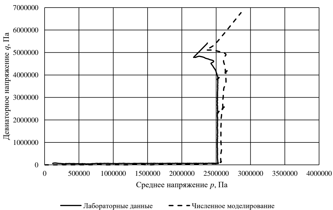
Рисунок 63 – Сравнение зависимости q(p) при численном моделировании и лабораторных испытаниях при испытании по модифицированной схеме Кармана с значением среднего напряжения p=2,5 МПа (составлено автором)
