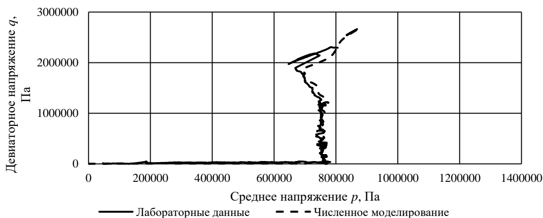
Рисунок 59 – Сравнение зависимости q(p) при численном моделировании и лабораторных испытаниях при испытании по модифицированной схеме Кармана с значением среднего напряжения p=0,75 МПа (составлено автором)
