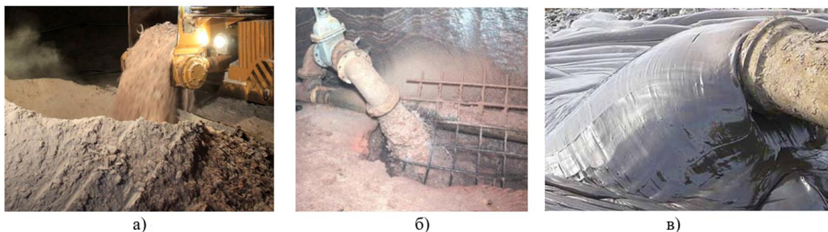
Рисунок 1 – Виды закладочных материалов: а) сыпучий закладочный массив; б) гидрозакладочный массив; в) пастообразный твердеющий массив (составлено автором)
