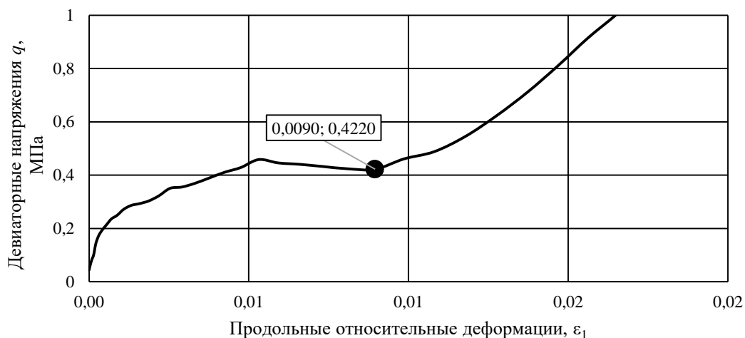
Рисунок 31 – Зависимость девиаторных напряжений и продольных относительных деформаций при соотношении \sigma_3/\sigma_1=0,35 (составлено автором)
