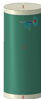
Рисунок 55 – Модель образца закладочного массива: 1 – верхняя и нижняя нагружающие плиты; 2 – образец закладочного материала (составлено автором)
