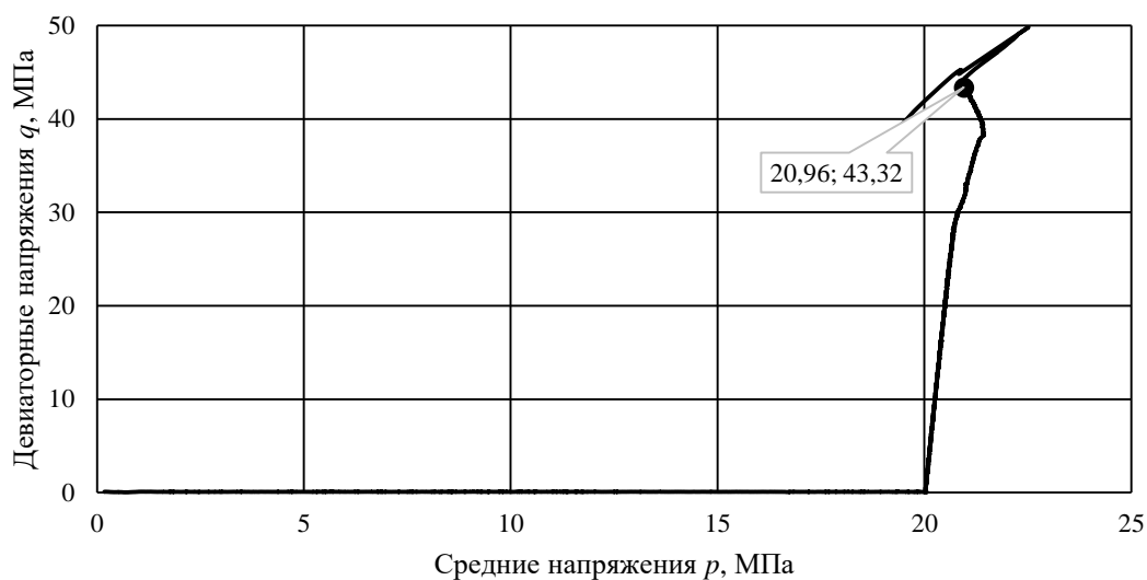
Рисунок 20 – Пример графика зависимости девиаторных напряжений q при выдержке постоянного значения средних напряжений p=20,0 МПа (составлено автором)
