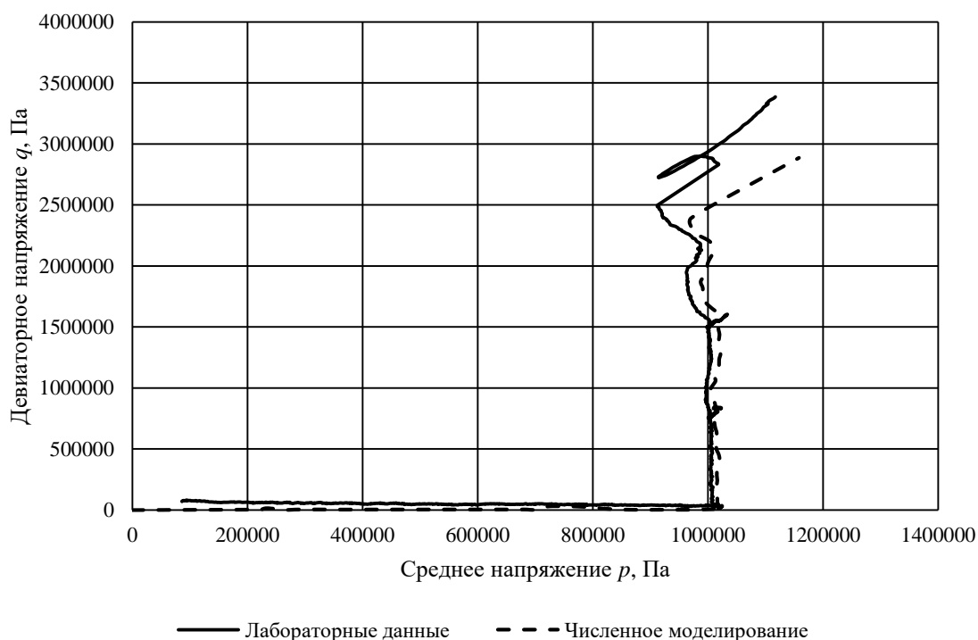
Рисунок 61 – Сравнение зависимости q(p) при численном моделировании и лабораторных испытаниях при испытании по модифицированной схеме Кармана с значением среднего напряжения p=1,0 МПа (составлено автором)
