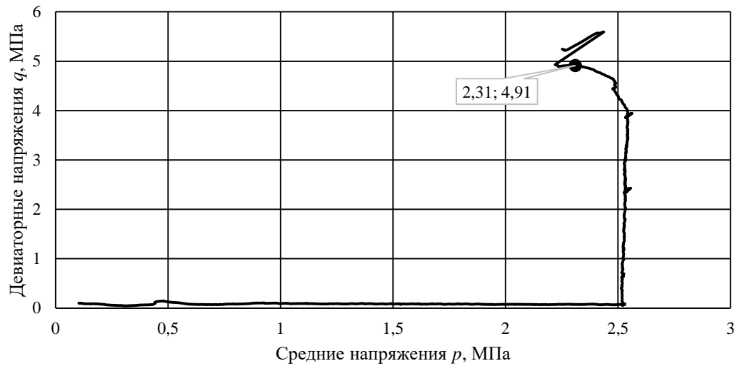
Рисунок 16 – Пример графика зависимости девиаторных напряжений q при выдержке постоянного значения средних напряжений p=2,5 МПа (составлено автором)
