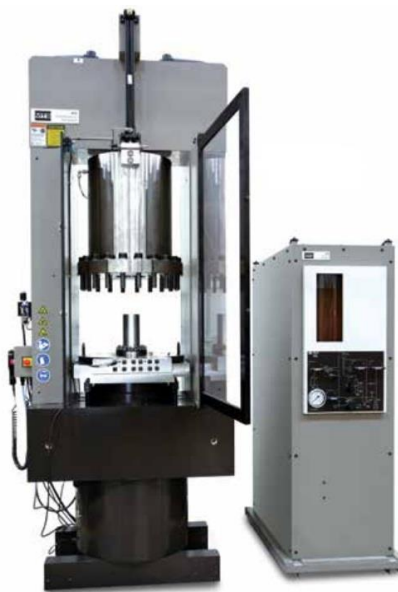
Рисунок 8 – Общий вид сервогидравлической испытательной установки MTS 815 (составлено автором)
