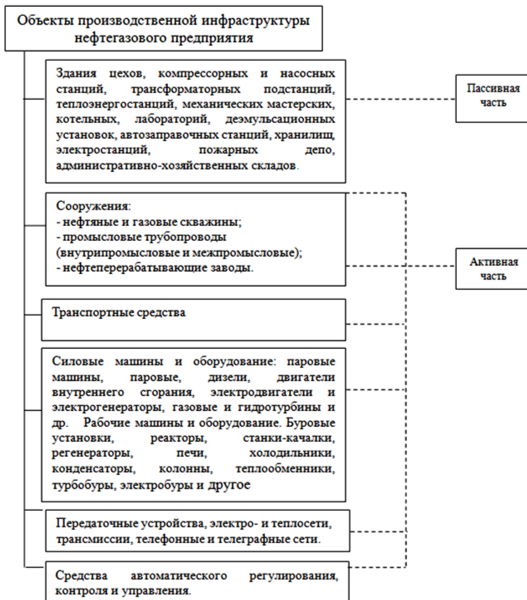
Рисунок 3 – Структура производственных объектов нефтегазового предприятия [19]
