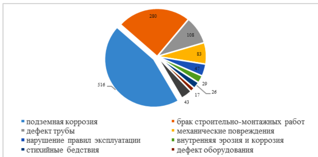
Рисунок 5 – Причины аварий на нефтепроводах в 1980-1990 гг. [33]
