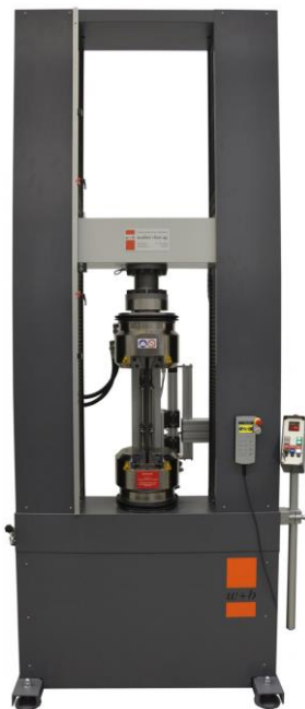
Рисунок 3.2 – Испытательная машина LFM-200 (фото автора)
