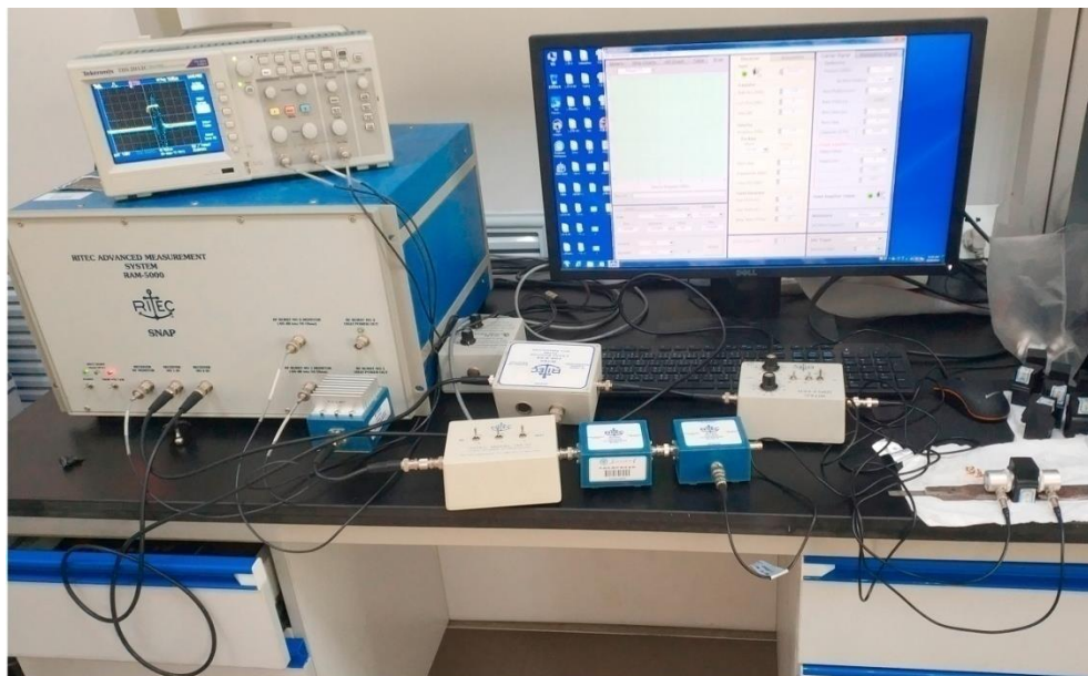
Рисунок 3.4 – Внешний вид экспериментальной установки линейно-направленной ультразвуковой измерительной системы (фото автора)
