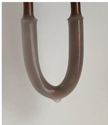
Рисунок 3.6 – Отложения парафина на «холодном стержне» (фото автора)
