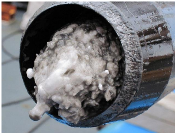
Рисунок 1.7 – Пример гидратной пробки в НКТ [46]
