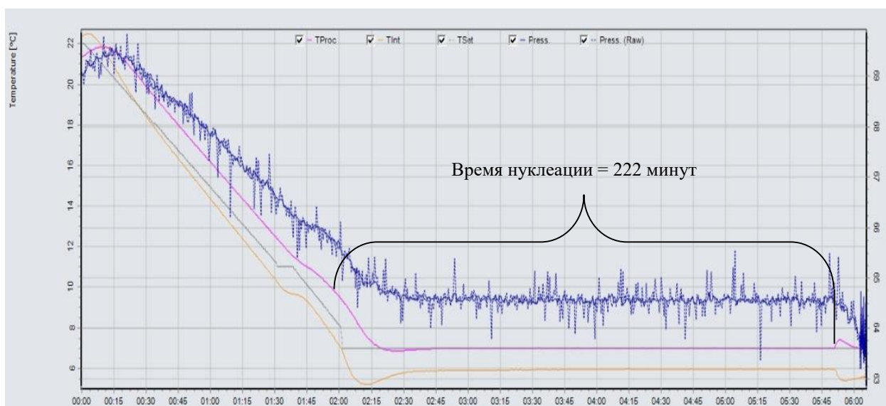
Рисунок 2.14 – Определение времени нуклеации газогидрата в первом эксперименте (составлено автором)
