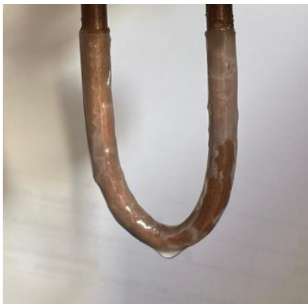
Рисунок 3.16 – Отложения парафина на «холодном стержне» после добавления ингибитора Dewaxol 7201 (фото автора)
