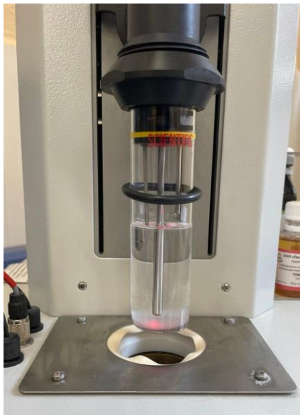
Рисунок 3.2 – Емкость с модельной смесью, установленная в установку ТПЗ-ЛАБ-22 (фото автора)
