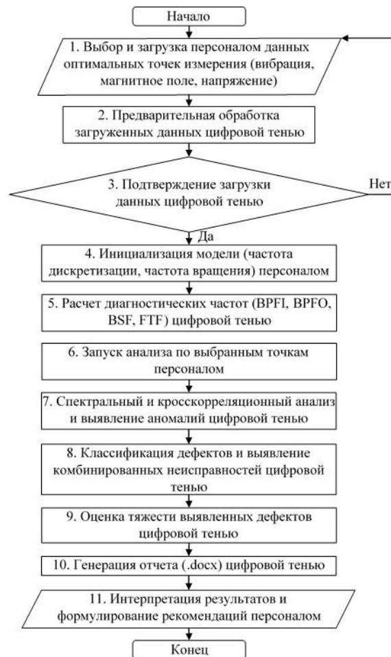
Рисунок 3.4 – Блок-схема последовательности взаимодействия персонала и цифровой тени (составлено автором)
