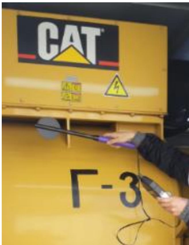
Рисунок 5.5 – Проведение измерений напряженности внешнего магнитного поля синхронного генератора (составлено автором)
