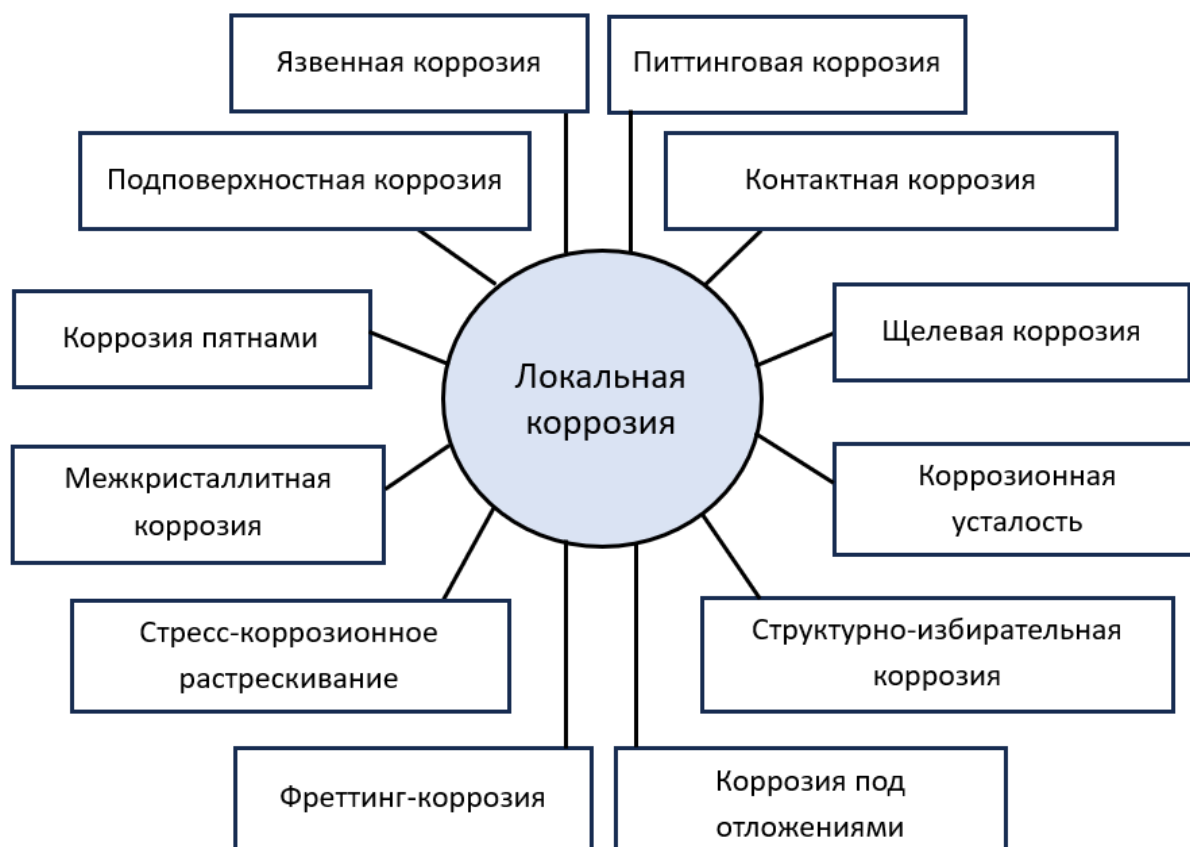
Рисунок 2.1 – Виды локальной коррозии (составлено автором)
