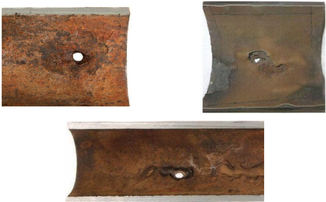
Рисунок 1.3 – Типичный вид сквозных язвенных поражений (свищей) стенки трубы промысловых нефтепроводов [9, 55]
