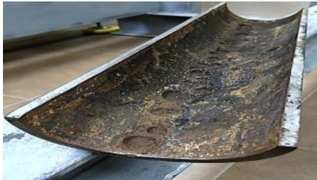
Рисунок 1.4 – Форма одиночных коррозионных язв в процессе их устойчивого роста [40]
