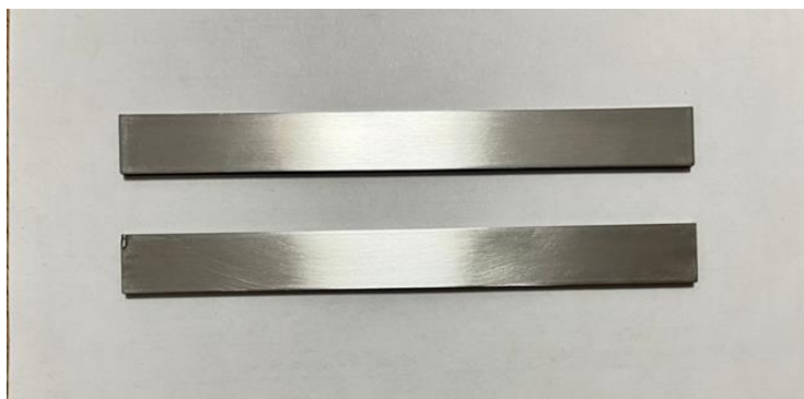
Рисунок 4.1 – Образцы в виде пластин после шлифовки и полировки (фото автора)
