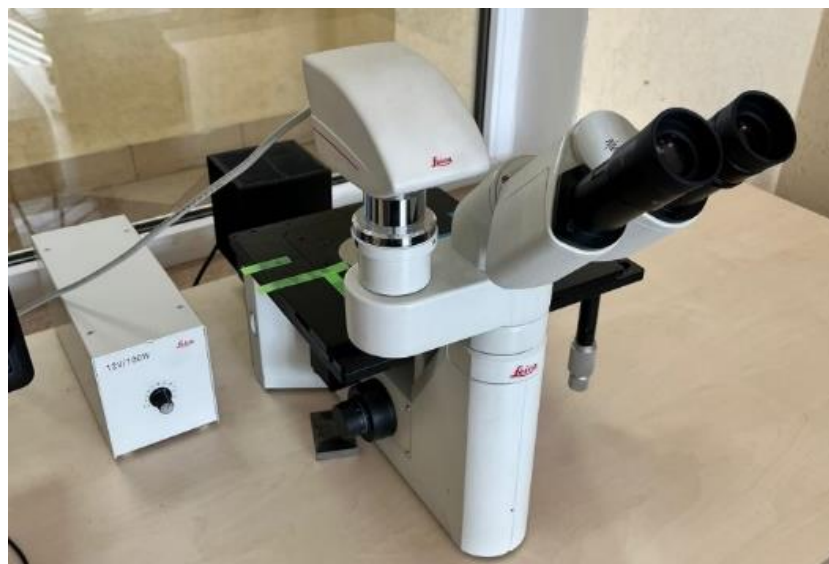
Рисунок 3.3 – Металлографический микроскоп Leica DMIL HS для проведения оптических измерений (фото автора)
