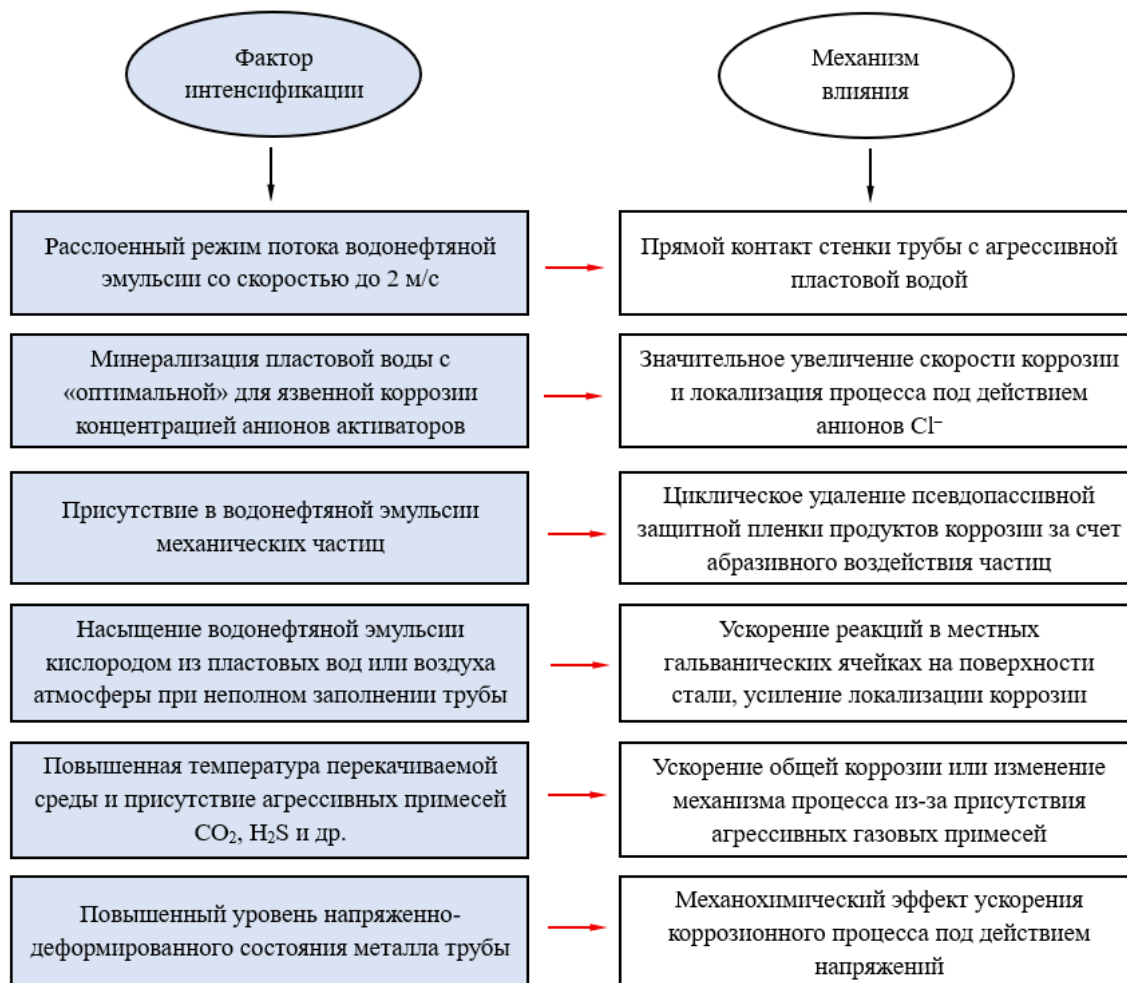
Рисунок 2.12 – Факторы, определяющие интенсификацию язвенной коррозии промысловых нефтепроводов (составлено автором)
