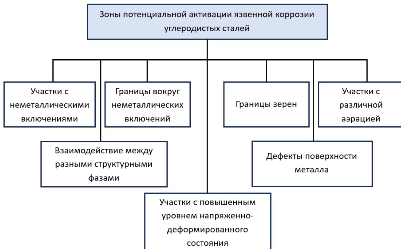
Рисунок 2.7 – Основные варианты зон активации язвенной коррозии углеродистых сталей (составлено автором)
