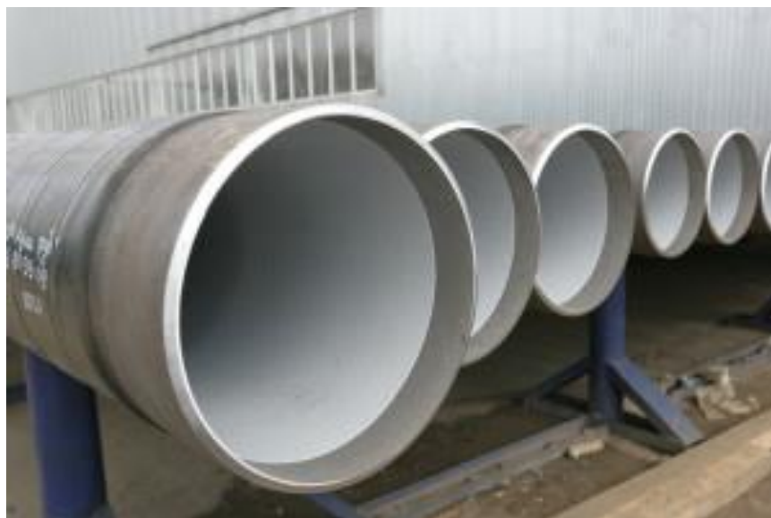
Рисунок 1.6 – Трубы с внутренним эпоксидным покрытием [11]
