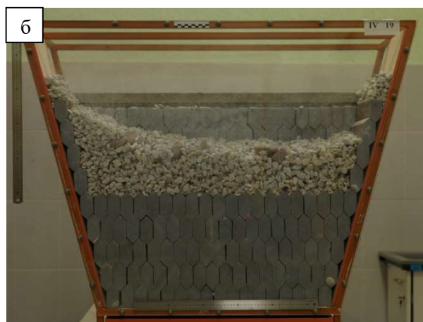
Рисунок 4 - Проведение лабораторных исследований по изучению процессов опускания предохранительной подушки
