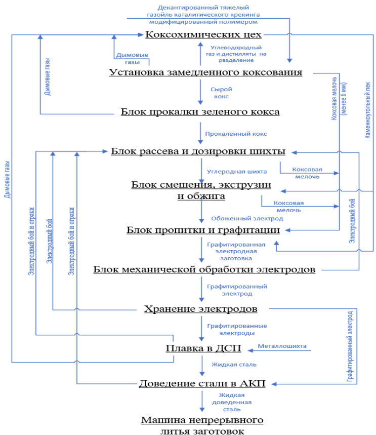
Рисунок 1 – Принципиальная технологическая схема полного цикла получения графитированных электродов
