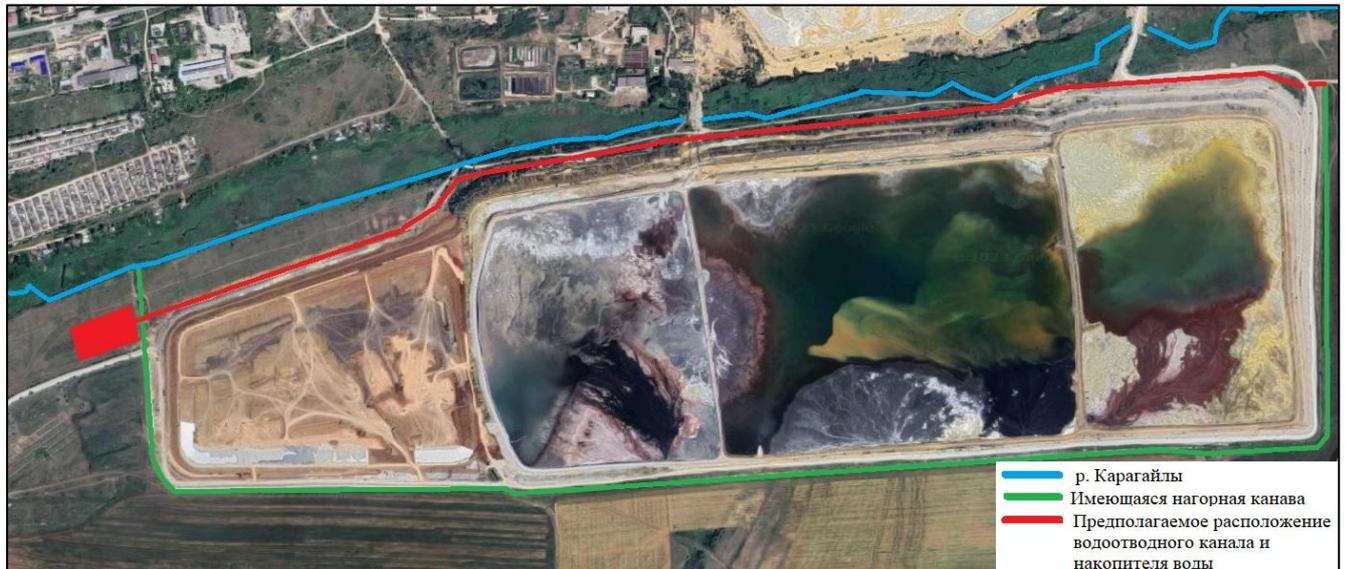
Рисунок 4.1 – Предлагаемое расположение водоотводного канала и накопителя воды
