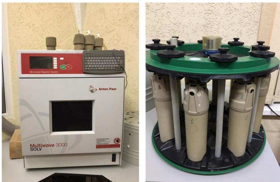
Рисунок 2.6 - Система микроволнового разложения Multiwave 3000
