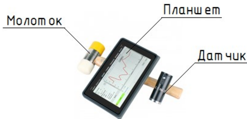
Рисунок 3.12 – Используемое оборудование: прибор Спектр 4.0
